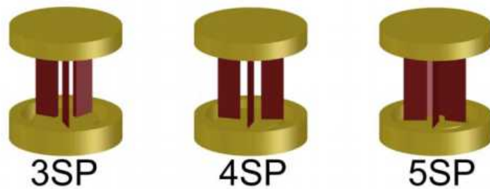
Gambar 5. Detail model bulb setiap variasi jumlah swing plate
