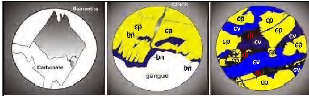
Gambar 7. Kenampakan yang menunjukkan tekstur replacement (Guilbert dan Park, 1986). a. Pseudomorf , bementit mengganti sebagian kristal karbonat, b. Bornit mengganti pada bagian tepi dan rekahan kalkopirit, dan c. Digenit yang mengganti kovelit dan kalkopirit, memperlihatkan lebar yang berbeda.
