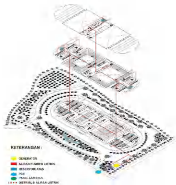
GAMBAR 1 13 Sistem Mekanikal elektrika
