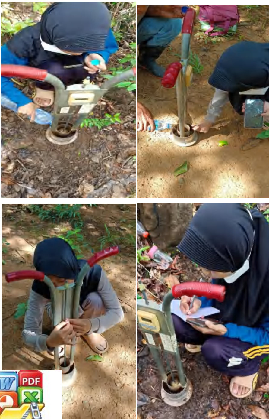
Lampiran 8. Dokumentasi kegiatan pengukuran laju infiltrasi di Lapangan
