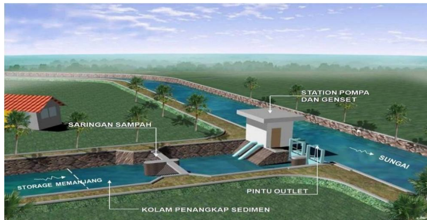
Gambar 11. Sistem polder dengan pompa dan kolam tipe storage memanjang
