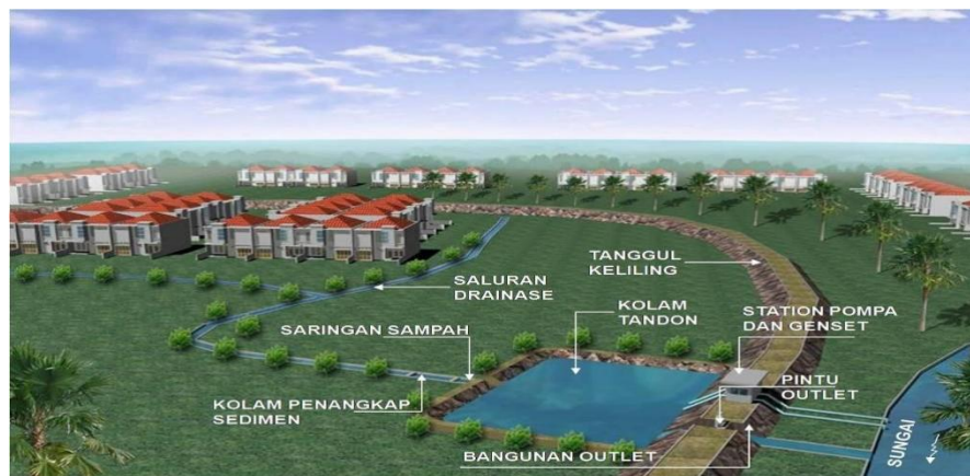
Gambar 10. Sistem polder dengan pompa dan kolam di dalam badan saluran/sungai
