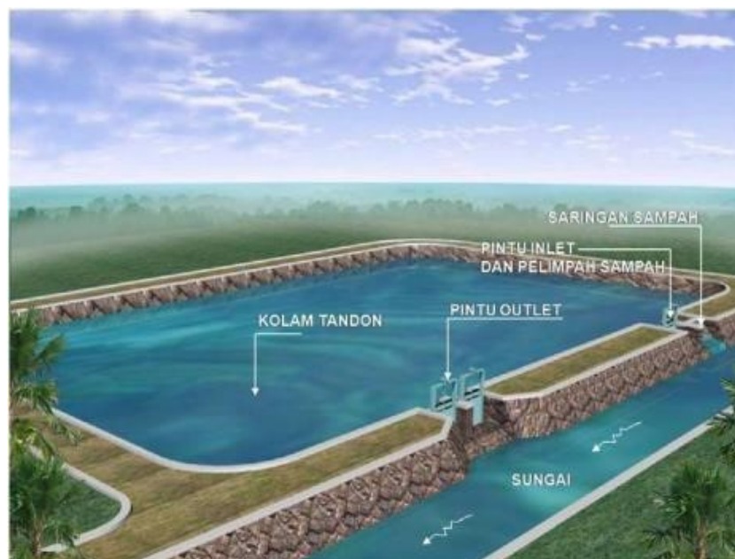
Gambar 2. Kolam Retensi Tipe di Samping Badan Sungai
