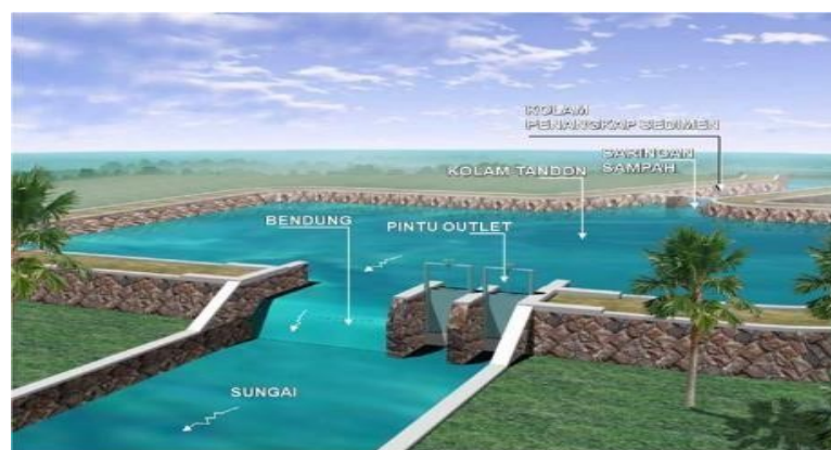
Gambar 3. Kolam Retensi di Dalam Badan Sungai
