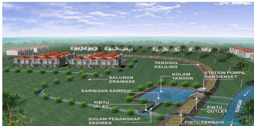
Gambar 9. Sistem polder dengan pompa dan kolam di samping badan saluran/sungai
