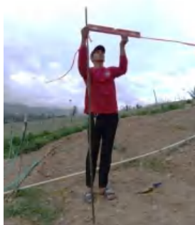
Gambar 6. Mengukur kemiringan lahan.
