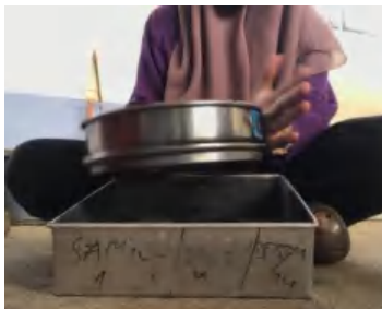
Proses penyaringan limbah ampas kopi yang telah dikarbonisasi
