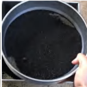
Proses penyaringan limbah ampas kopi yang telah dikarbonisasi
