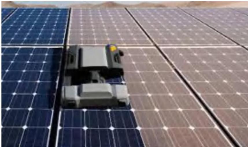
**Gambar 4** PV yang dibersihkan secara otomatis (Kazem et al., 2020)
