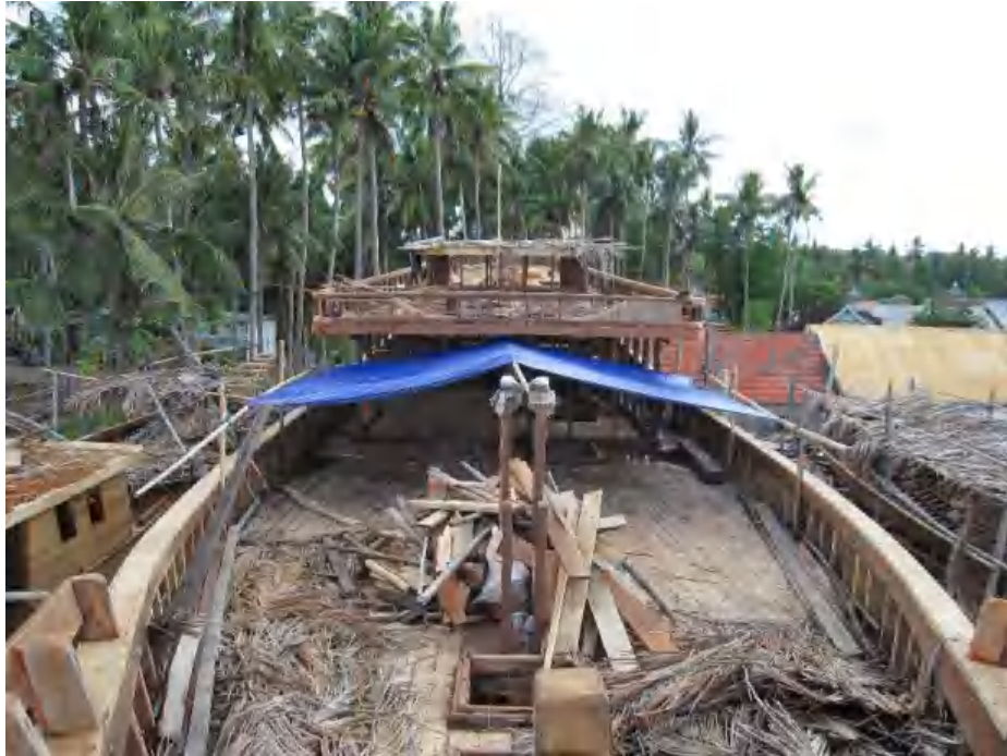
Gambar 106 Geladak dan bangunan atas kapal Pinisi
