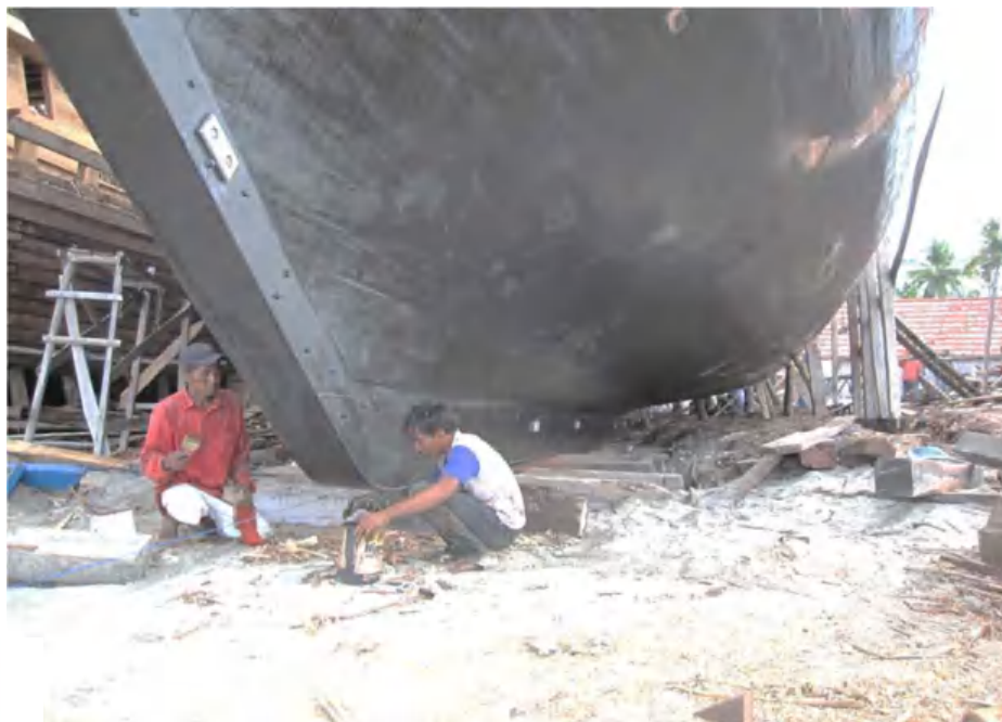
Gambar 105 Lunas dan Lambung kapal Pinisi
