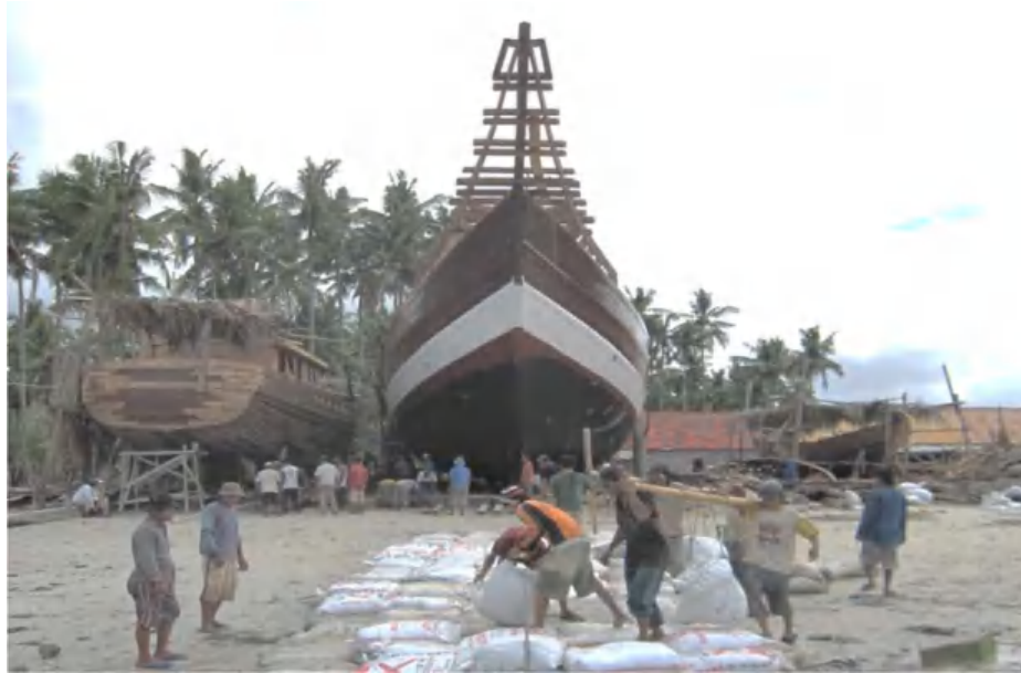
Gambar 104 Kapal Pinisi proses peluncuran Tradisional
