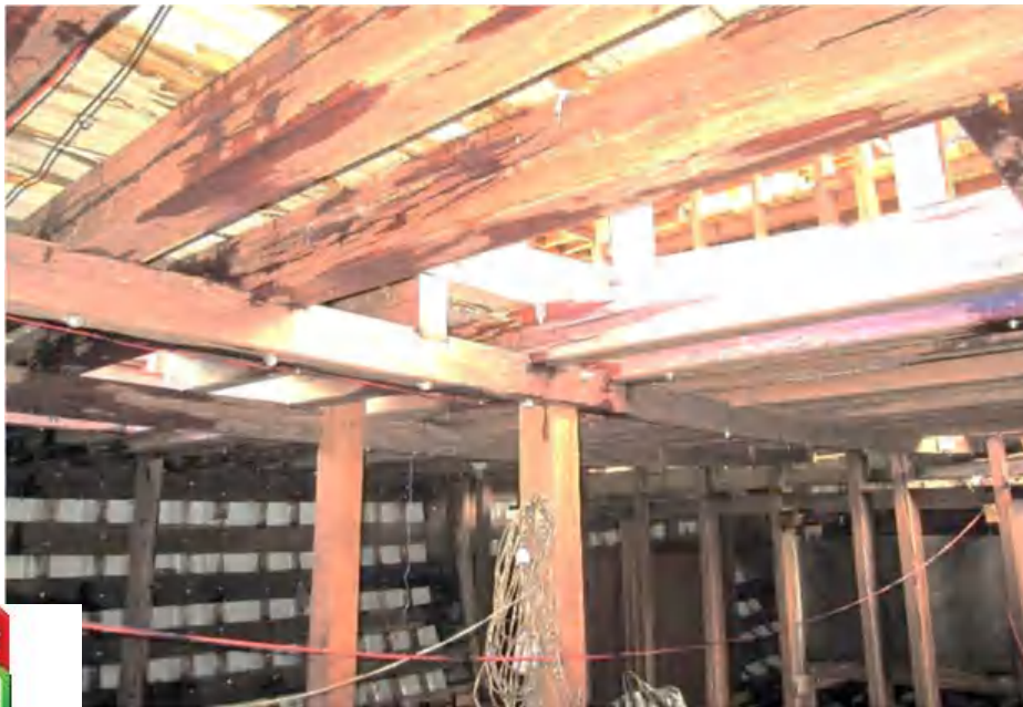
Gambar 107 Struktur midship kapal Pinisi
