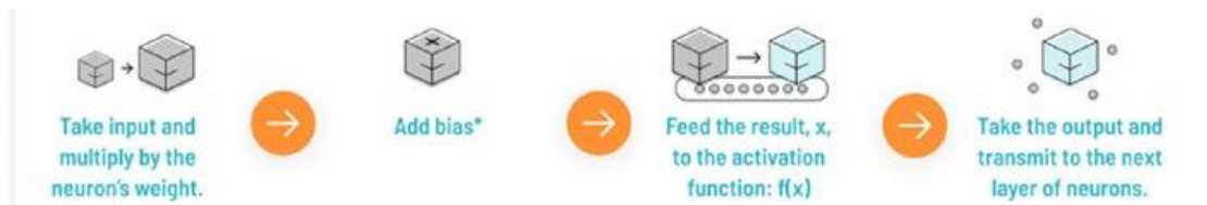
Gambar 2. 13 Langkah-langkah cara kerja fungsi aktivasi di neuron
