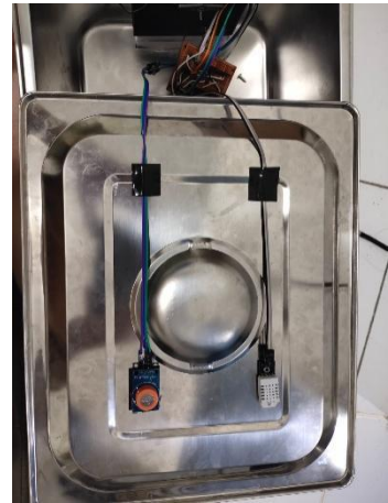
Pemasangan sensor MQ3 dan DHT22 pada tutup wadah
