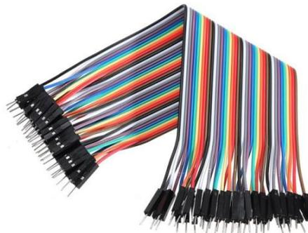
Gambar 2.11. Kabel Jumper
