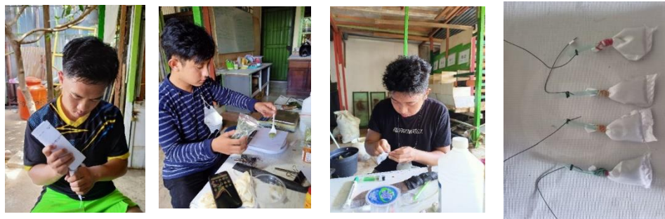
Gambar 7. Pemasukan sampel pakan pada nylon bag
