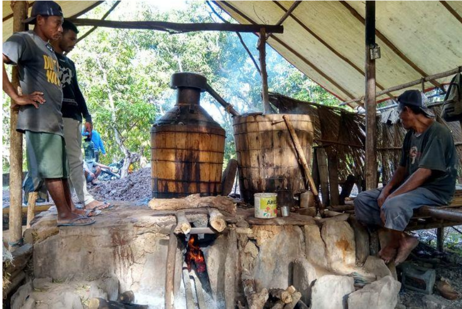
Gambar; Proses penyulingan minyak kayu putih
