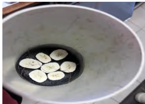
Gambar 18. Sampel dikeringkan dengan pengeringan fluidized bed dryer
