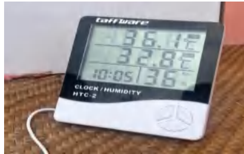
Gambar 16. Mengukur suhu udara dan kelembapan relatif menggunakan thermohygrometer
