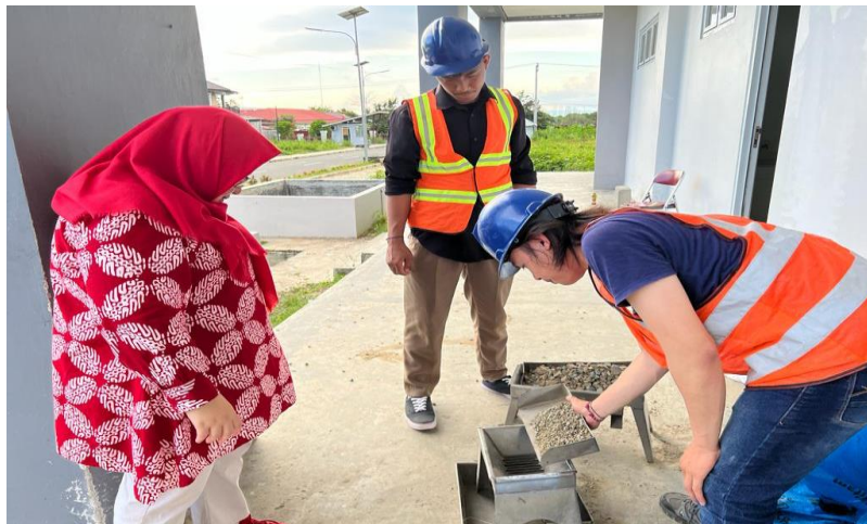
Proses pemilihan dan verifikasi material alam (agregat) berdasarkan kebutuhan/proses penyaringan
