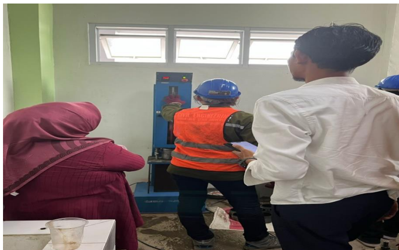
Proses pemadatan menggunakan Hammer (mesin penumbuk)
