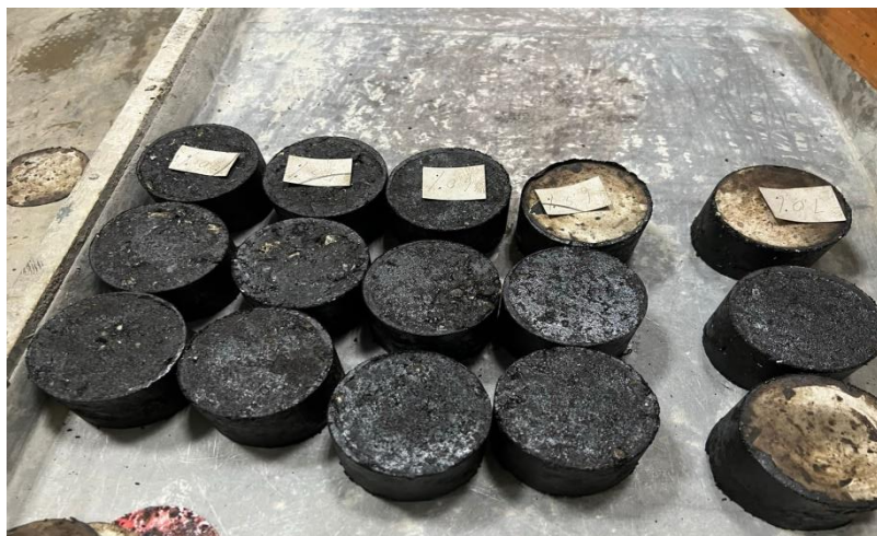
Material/benda uji siap untuk dilakukan pengujian Marshall
