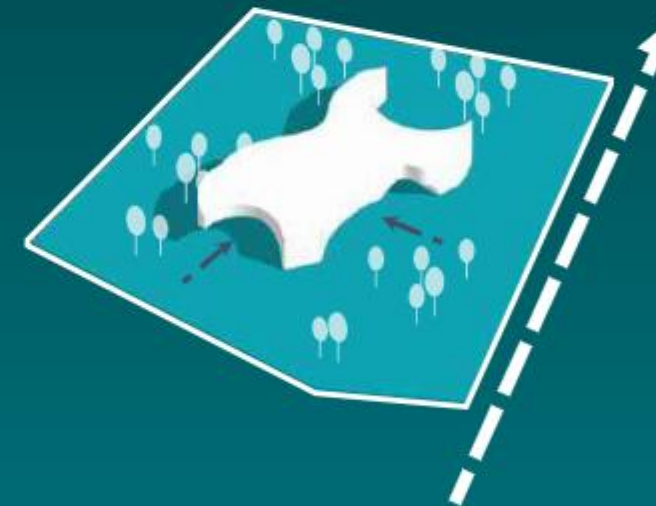
7 FINISHING Tampak atas bangunan setelah diolah bentuk, pada bagian samping kita subtraktif agar bisa memberikan kesan dinamis. Selain itu juga berfungsi untuk pencahayaan dan penghawaan alami pada bangunan
