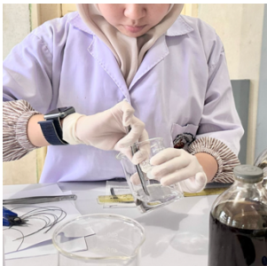
Kawat dibersihkan dengan metanol
