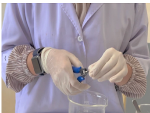
Kawat dipreparasi sepanjang 2 cm
