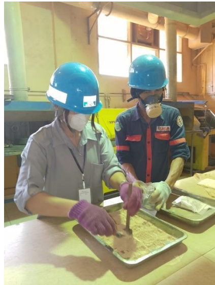
Sampel diambil menggunakan sendok 1D kemudian dimasukkan kedalam plastik sampel
