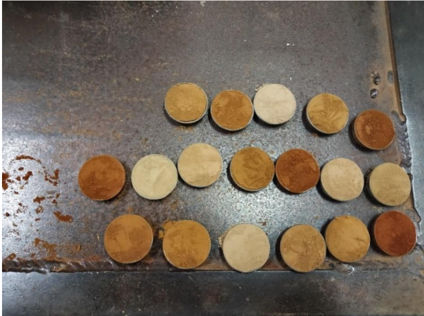
Sampel yang di aluminium cup soil akan dipadatkan
