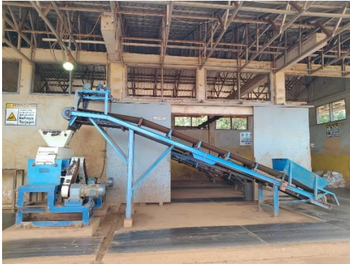
Proses mereduksi sampel menggunakan Doble roll chruser dan ayakan -20mm
