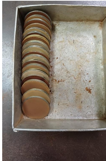
Sampel dipadatkan menggunakan mesin press pellet
