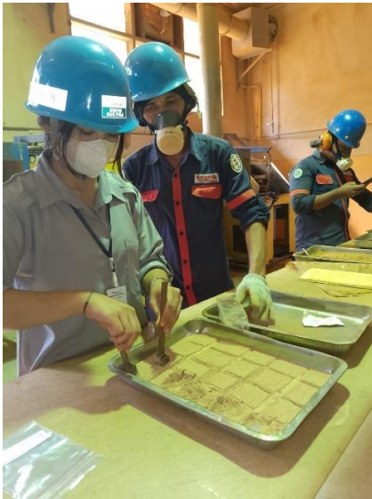
Sampel diambil menggunakan sendok 1D kemudian dimasukkan kedalam plastik sampel
