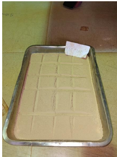
Sampel dimasukkan kedalam talang kemudian tuang ke dalam plastic roll , lalu mixing sampel sebanyak 20 kali untuk menghomogenkan sampel setelah itu sampel dituang kedalam papan matriks lalu diratakan dan dimatriks 4x5
