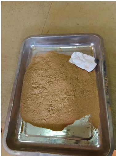
Sampel dimasukkan kedalam talang kemudian tuang ke dalam plastic roll , lalu mixing sampel sebanyak 20 kali untuk menghomogenkan sampel setelah itu sampel dituang kedalam papan matriks lalu diratakan dan dimatriks 4x5
