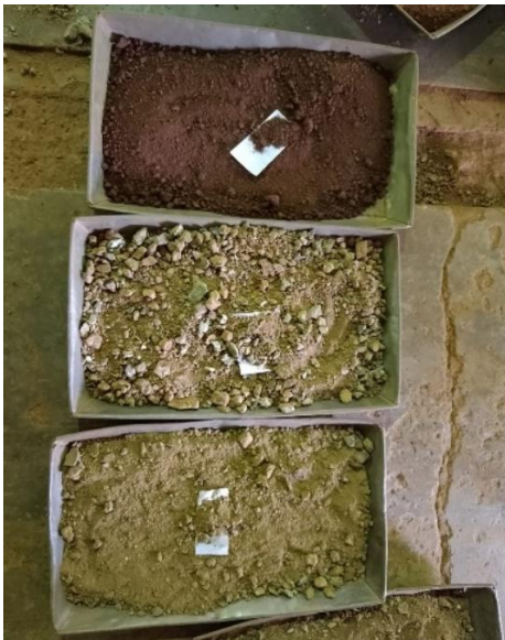
Sampel dimasukkan kedalam talang kemudian di oven dengan suhu 105°C selama 4,5 jam.
