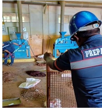
Proses mereduksi sampel menggunakan Doble roll chruser dan ayakan -20mm
