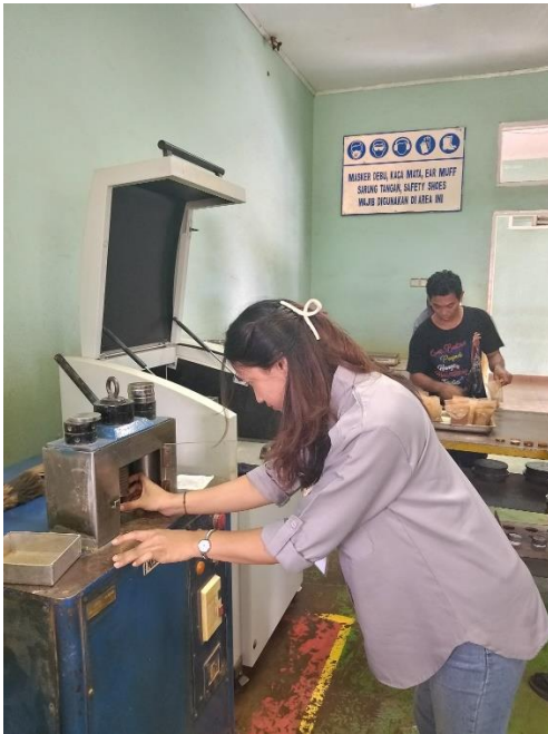
Sampel dipadatkan menggunakan mesin press pellet
