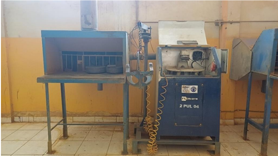
Sampel direduksi kembali dengan ukuran 200 mesh menggunakan alat pulverizer dengan estimasi waktu kurang lebih 5 menit
