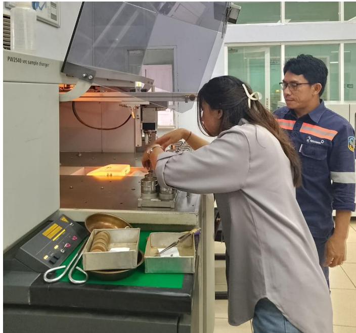
Sampel dianalisis menggunakan alat XRF
