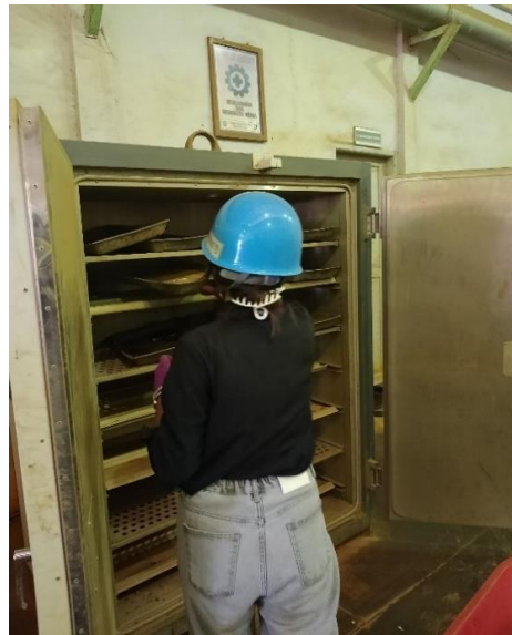
Sampel dimasukkan kedalam talang kemudian di oven dengan suhu 105°C selama 4,5 jam.
