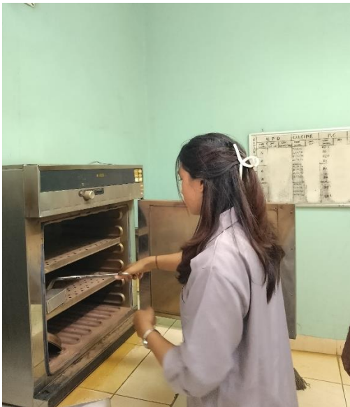
Sampel yang sudah dipadatkan kemudian dimasukkan ke dalam oven untuk dipanasi lagi untuk meminimalisasi kadar air sekitar 10 menit dengan suhu 105^{\circ}\text{C} lalu dibawa menuju laboratorium X-Ray disertai dengan kode sampel untuk dianalisis
