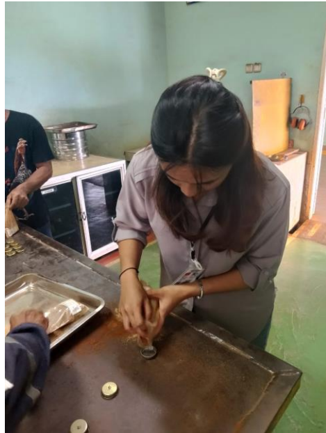
Sampel dimasukkan kedalam aluminium cup soil untuk dipadatkan
