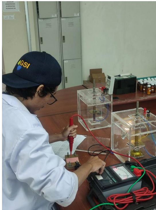
Lampiran 16. Pengambilan data resistansi permukaan
