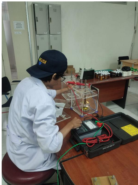
Lampiran 15. Pengambilan data resistansi volume
