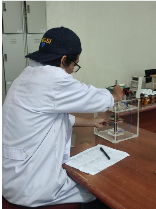
Lampiran 15. Pengambilan data resistansi volume
