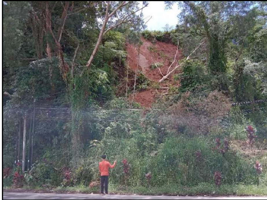
Gambar 6 Kenampakan gerakan tanah yang memiliki bidang gelincir ( Debris slide ) pada stasiun 90 di daerah Buntu dengan arah foto N 78°E
