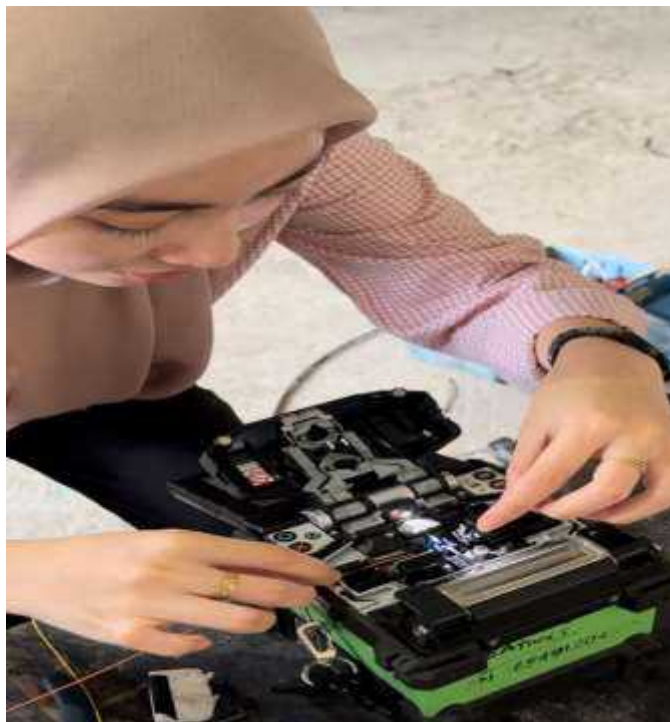
Lampiran 2 Proses penyambungan serat optik pada fusion splicer
