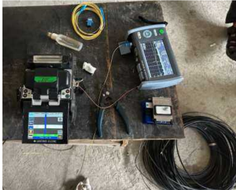
Lampiran 2 Proses penyambungan serat optik pada fusion splicer
