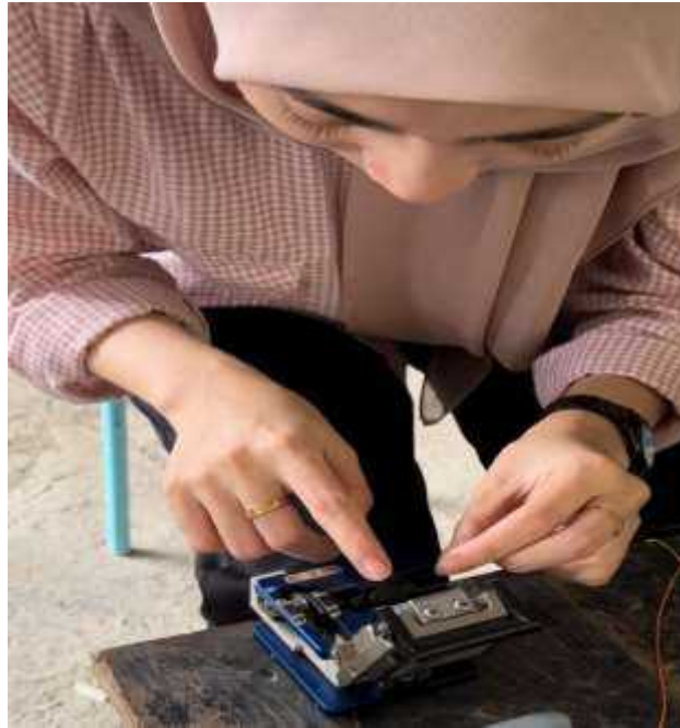
Lampiran 3 Proses pemotongan serat optik dengan fiber cleaver
