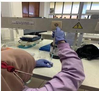
Proses penambahan larutan baku standar ke dalam larutan teosal yang telah diencerkan
