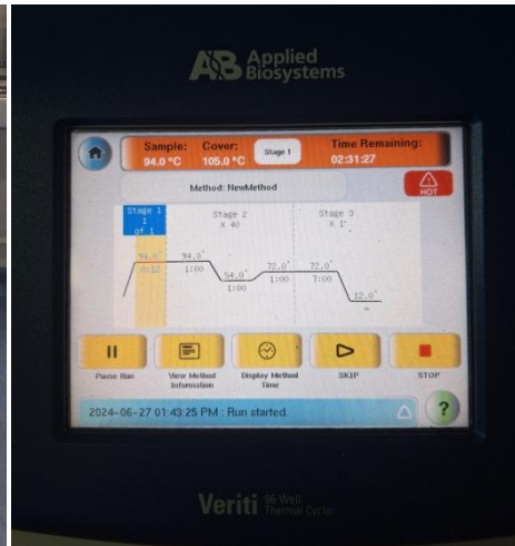
Gambar 16. Tahapan PCR, tahapan dan waktu
