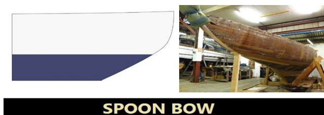
Gambar 4. Haluan kapal spoon bow Sumber: Ilmu kapal dan logistik, 2023
