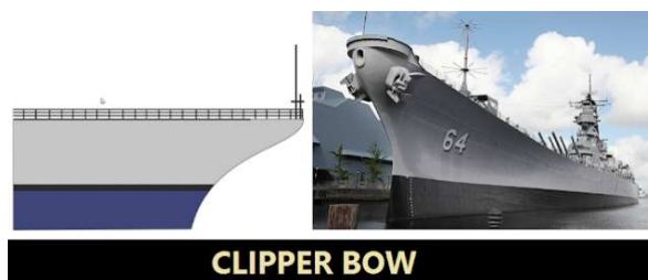
Gambar 3. Haluan kapal clipper bow Sumber: Ilmu kapal dan logistik, 2023
