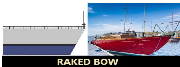
Gambar 2. Haluan kapal raked bow
