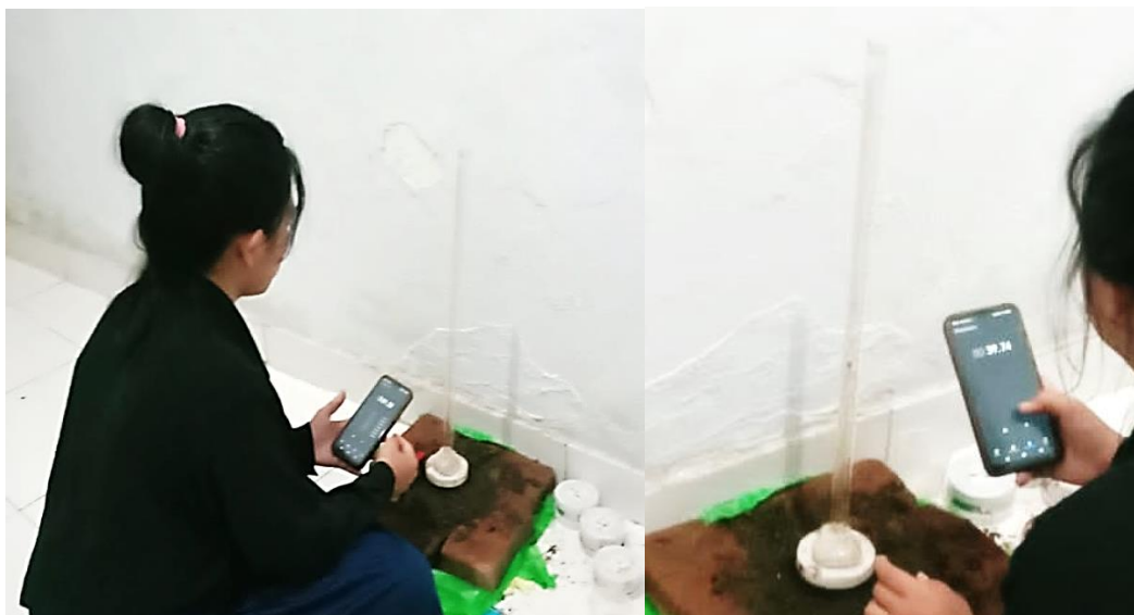
Gambar 15. Pengukuran Sampel dengan Metode Falling-Head .
