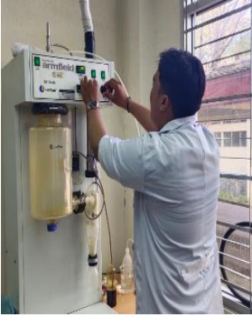
Pengeringan dengan Spray Dryer
