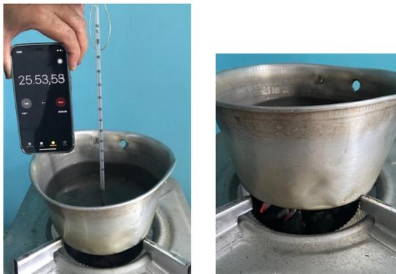
**Gambar 81. Proses Perbandingan Masak Air dengan Arang Kayu**
