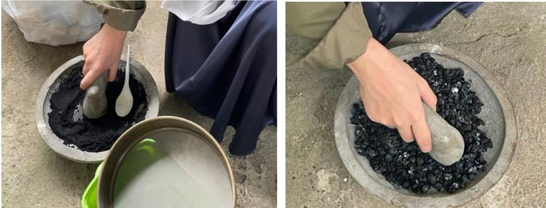
**Gambar 39. Proses Penghalusan Arang Tongkol Jagung dan Cangkang Kopi Menggunakan Lesung Batu**
