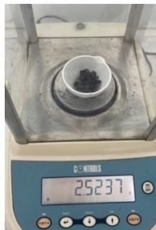
**Gambar 67. Penimbangan Sampel Briket Sebelum Masuk ke *Furnace***
