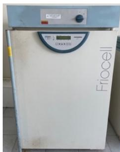
Sebagai alat steril dan mengeringkan cawan porselin untuk pengujian proksimat
