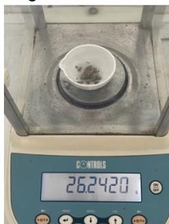
**Gambar 70. Penimbangan Sampel Briket Setelah di *Furnace***
