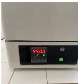
**Gambar 73. Pengaturan Suhu *Furnace* untuk Uji Zat mudah menguap**
