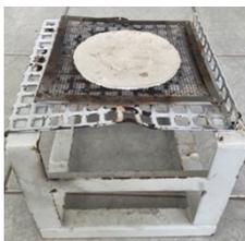
Meletakkan sampel briket pada saat pengujian laju pembakaran
