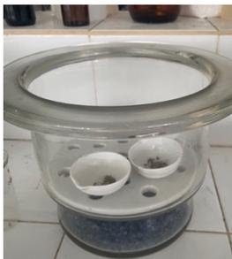
**Gambar 69. Proses Pendinginan Sampel Briket di Dalam Desikator**
