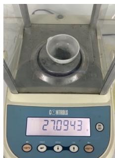
**Gambar 64. Penimbangan Sampel Briket Setelah Dioven**
