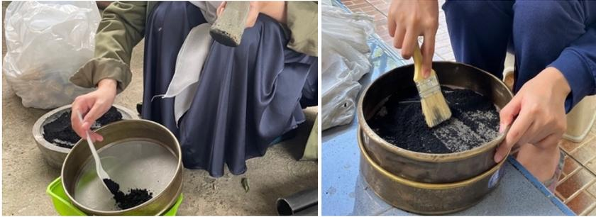
**Gambar 41. Proses Pengayakan Menggunakan Ayakan 30 dan 50 Mesh**
