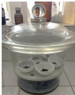
**Gambar 63. Proses Pendinginan Sampel Briket di Dalam Desikator**
