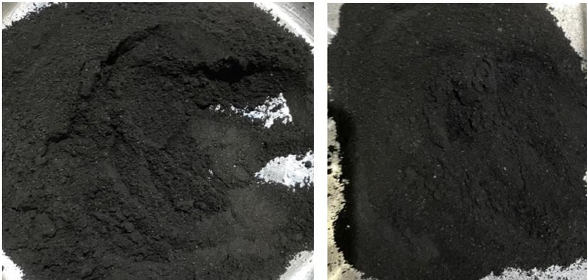
**Gambar 42. Perbandingan Arang Tongkol Jagung dan Cangkang Kopi Setelah Penghalusan 30 Mesh**
