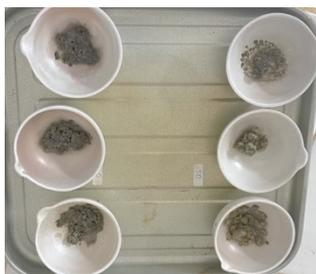
**Gambar 74. Residu dari Pengujian Zat Mudah Menguap**
