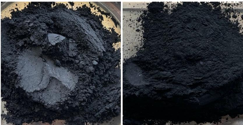
**Gambar 43. Perbandingan Arang Tongkol Jagung dan Cangkang Kopi Setelah Penghalusan 50 Mesh**
