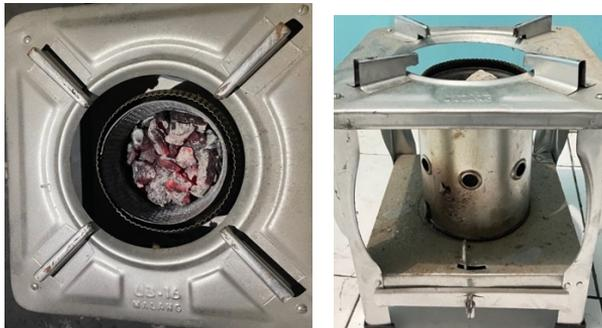
**Gambar 79. Memasukkan Briket ke Dalam Tungku Pembakaran**
