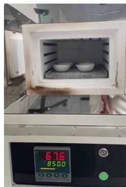
**Gambar 68. Cawan Porselen Berisi Sampel dimasukkan ke *Furnace***
