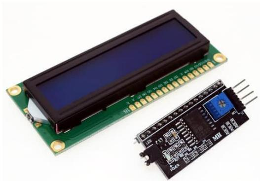
Gambar 14. LCD 16x2 dan Modul I2C
