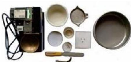
Gambar 9. Alat pengujian batas-batas *Atterberg*
