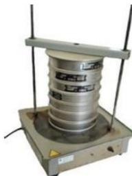
Gambar 10. Alat pengujian analisa saringan
