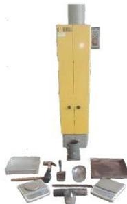
Gambar 12. Alat pengujian kompaksi
