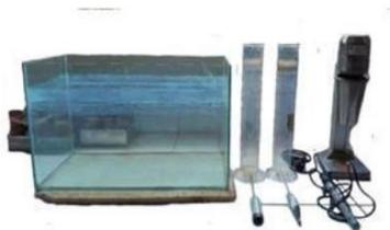
Gambar 11. Alat pengujian analisa hidrometer
