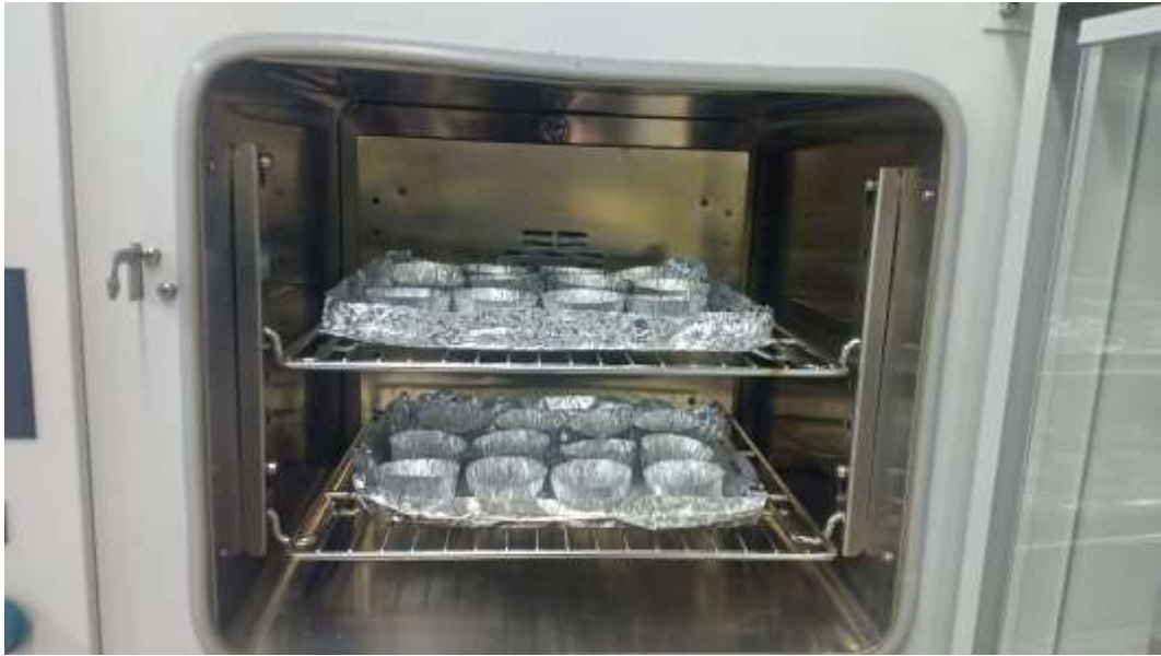
Gambar 16. Penyimpanan Menggunakan Oven dengan Suhu 105 °C Selama 72 Jam.
