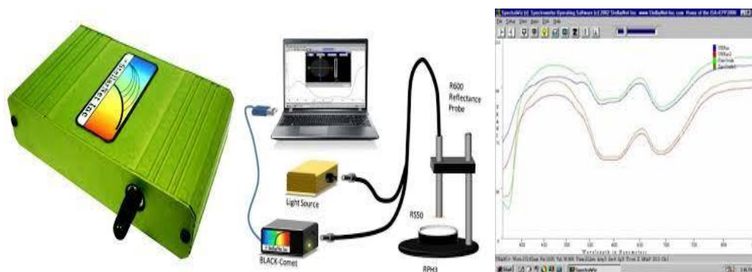
Gambar 2. Pemasangan Instrumen Utama dan Pembacaan Data Sampel.
