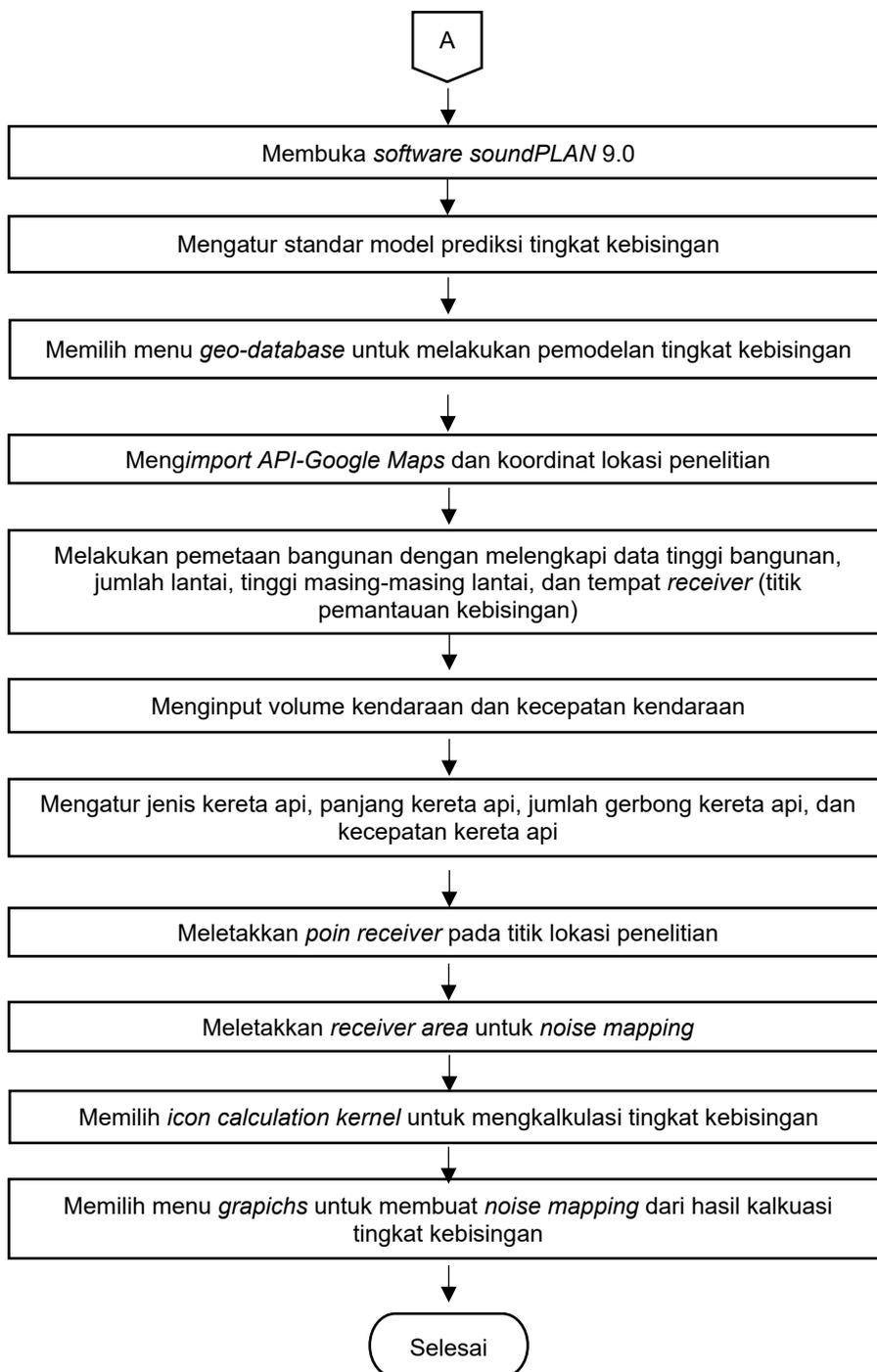
**Gambar 9.** Flowchart analisis prediksi dan pemetaan tingkat kebisingan menggunakan software soundPLAN
