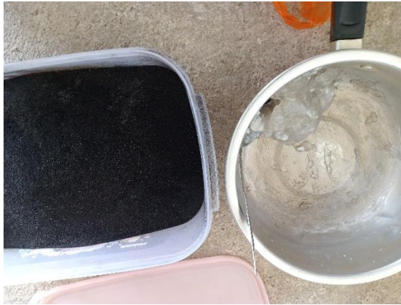
Gambar 12. Pencampuran sampel dengan lem sagu
