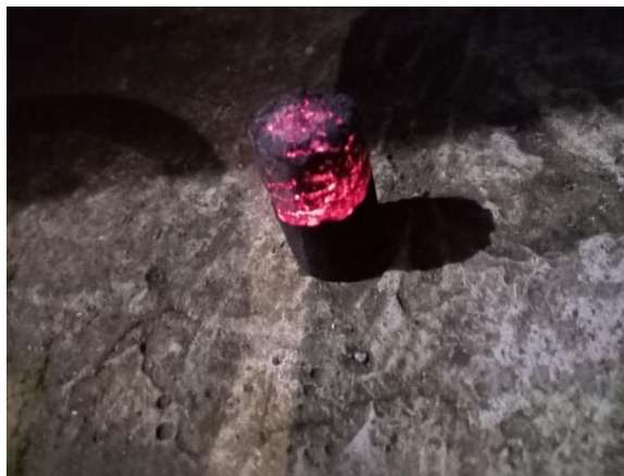
Gambar 15. Proses pengujian pembakaran briket
