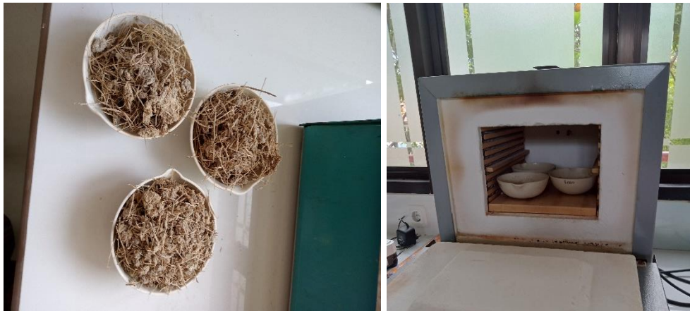
Gambar 9. Sampel ampas sagu sebelum di bakar
