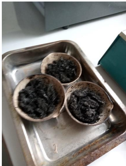
Gambar 10. Sampel ampas sagu setelah dibakar.
