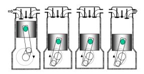
Gambar 1 Siklus Kerja Mesin Diesel 4 Tak Sumber : Teori Mesin Diesel (Samlawi, 2015)
