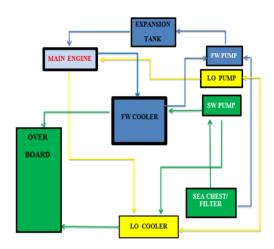
Gambar 2 Skema Sistem Pendingin
