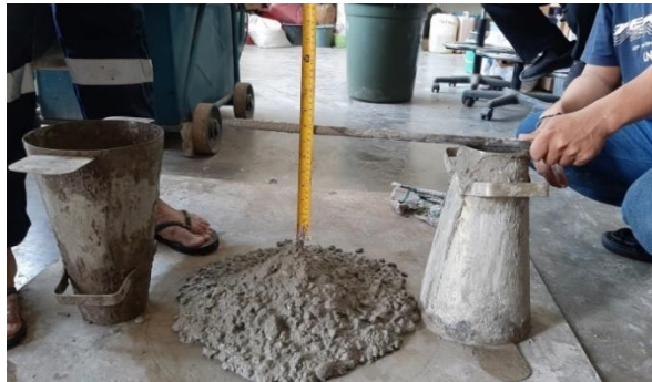
Gambar 11 Pemeriksaan uji slump beton
