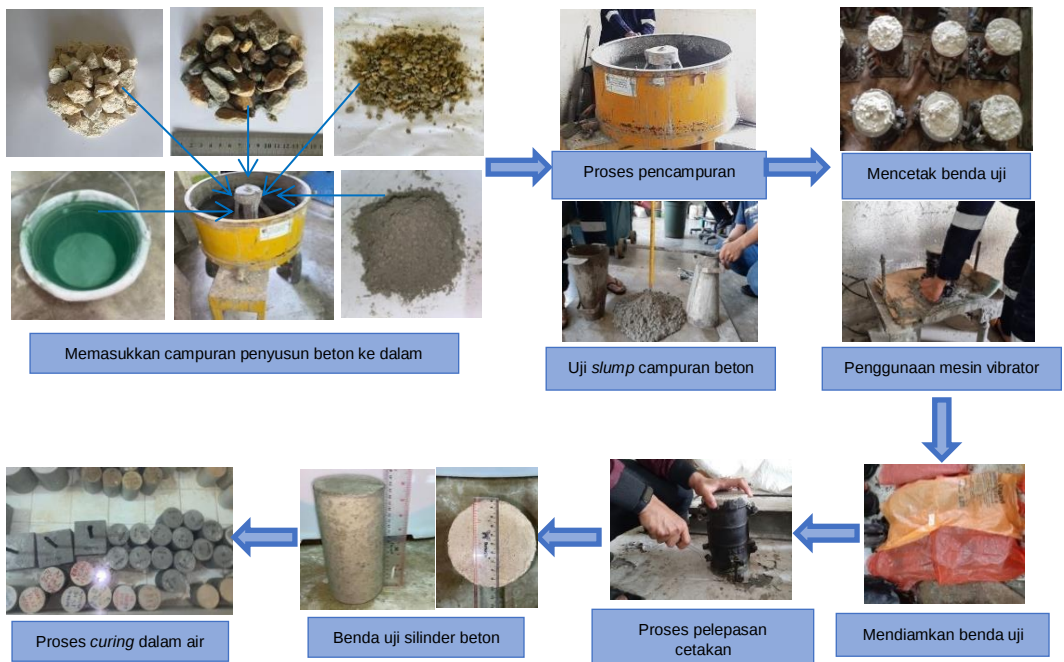
Gambar 10 Proses pembuatan benda uji beton
