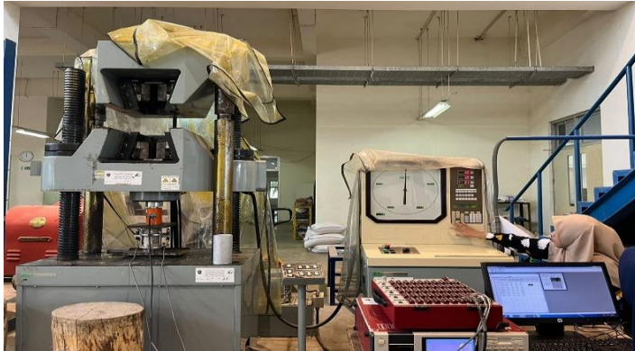
Gambar 13 Pengujian kuat tekan
