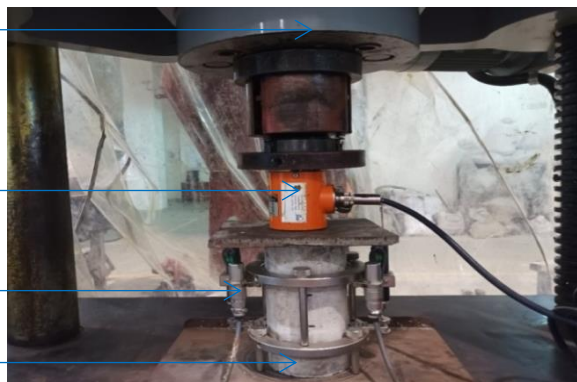
Gambar 14 Pengujian modulus elastisitas
