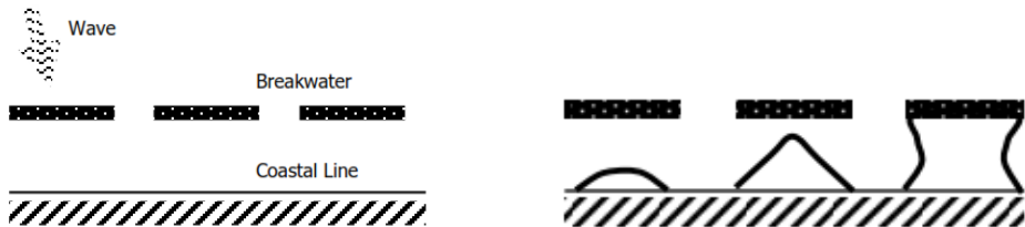
Gambar 18 Offshore breakwater dan pembentukan tombolo pada pantai yang dipasang breakwater
