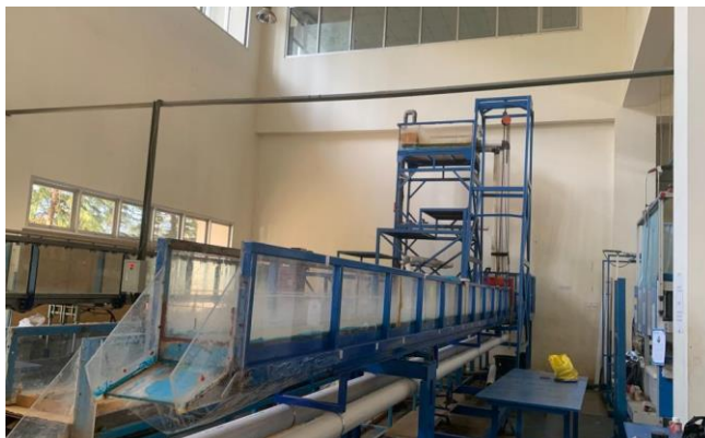
Gambar 8 Recirculating flume yang digunakan untuk uji model
