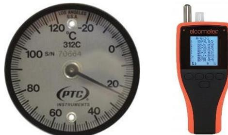
Gambar 5 Alat untuk mengetahui mengetahui suhu petal pada konstruksi
