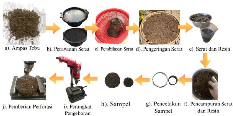
**Gambar 4. Proses Pembuatan Sampel Komposit Ampas Tebu**
