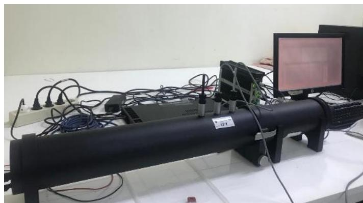
**Gambar 10. Perangkat Pengujian Tabung impedansi**
