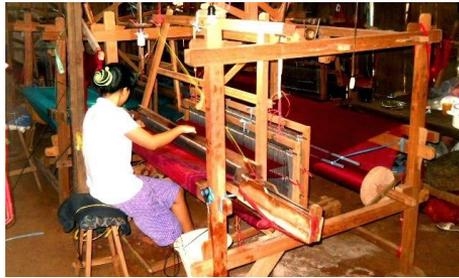
**Gambar 2.** Alat tenun bukan mesin
