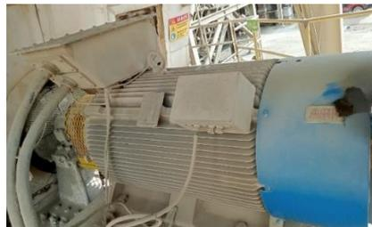
Gambar 5 Motor induksi tiga fasa di industri. Sumber: Dokumentasi lapangan
