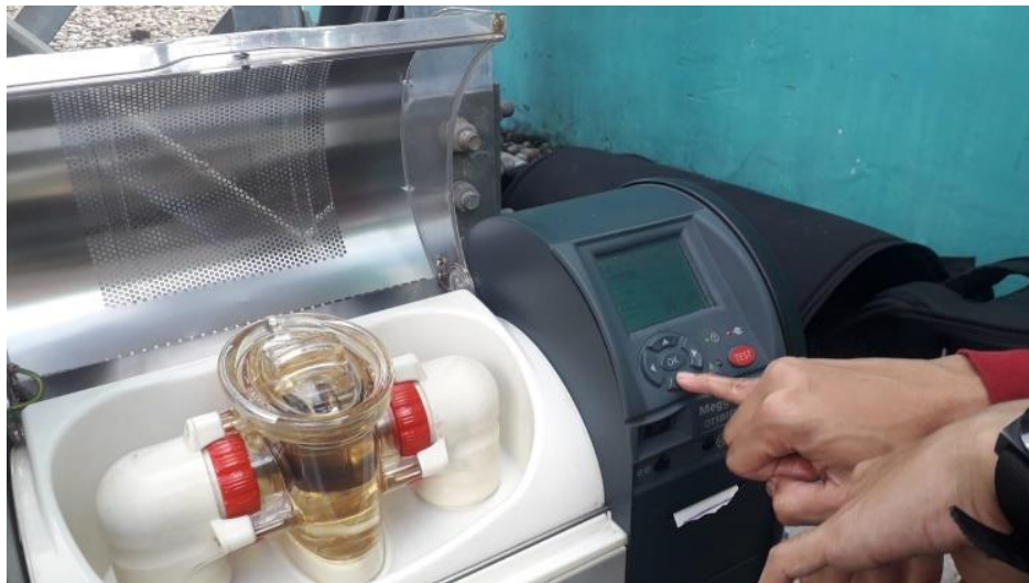
Gambar 7 Pengujian minyak trafo
