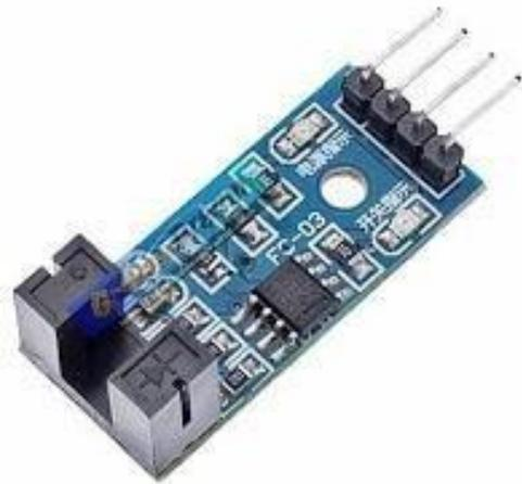
Gambar 8 Modul Sensor Kecepatan (LM393)
