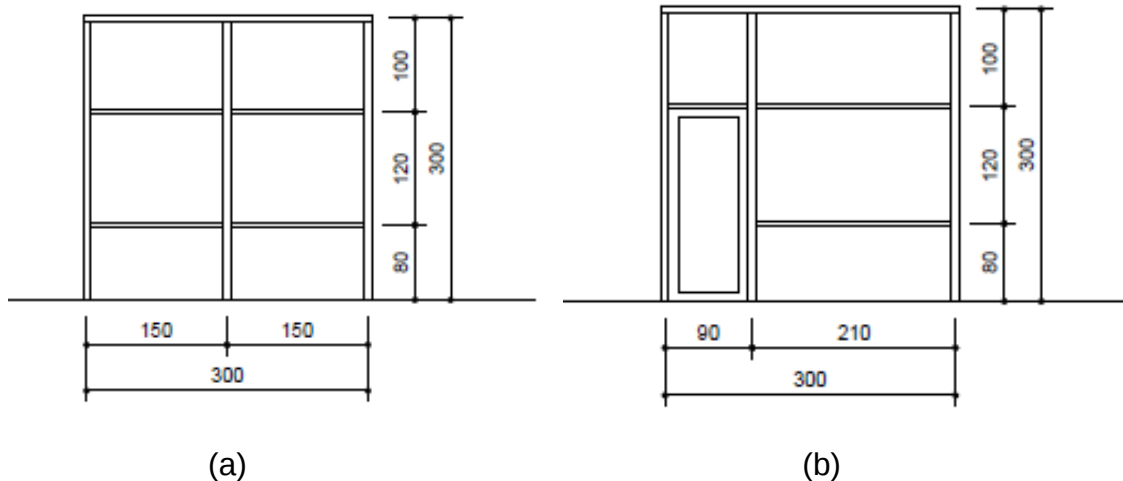
Gambar 5.5 (a) Pola 4 yang sering muncul pada dinding lebar 3 m tanpa bukaan. (b) dengan bukaan pada rumah Kancingan yang dibangun tahun 1950-1960an.
