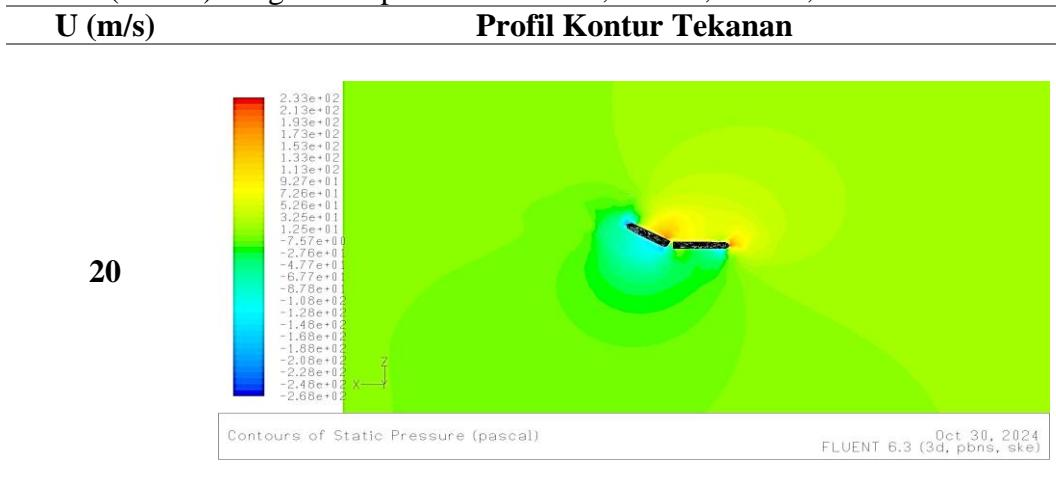
Tabel A. 27 Profil kontur tekanan pada *stabilizer* dan *rudder* untuk sudut ( $\delta = 35^\circ$ ) dengan kecepatan  $U = 12 \text{ m/s}$ ,  $14 \text{ m/s}$ ,  $18 \text{ m/s}$ , dan  $20 \text{ m/s}$
