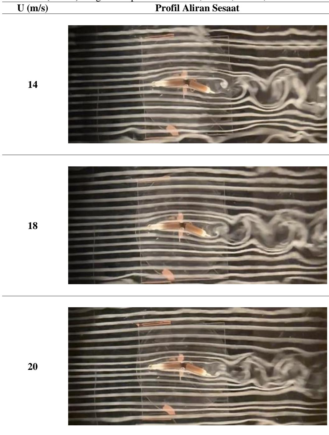
Tabel A. 15 Karakteristik aliran melintasi *stabilizer* dan *rudder* untuk sudut ( $\delta = 25^\circ$ ) dengan kecepatan  $U = 12 \text{ m/s}$ ,  $14 \text{ m/s}$ ,  $18 \text{ m/s}$ , dan  $20 \text{ m/s}$
