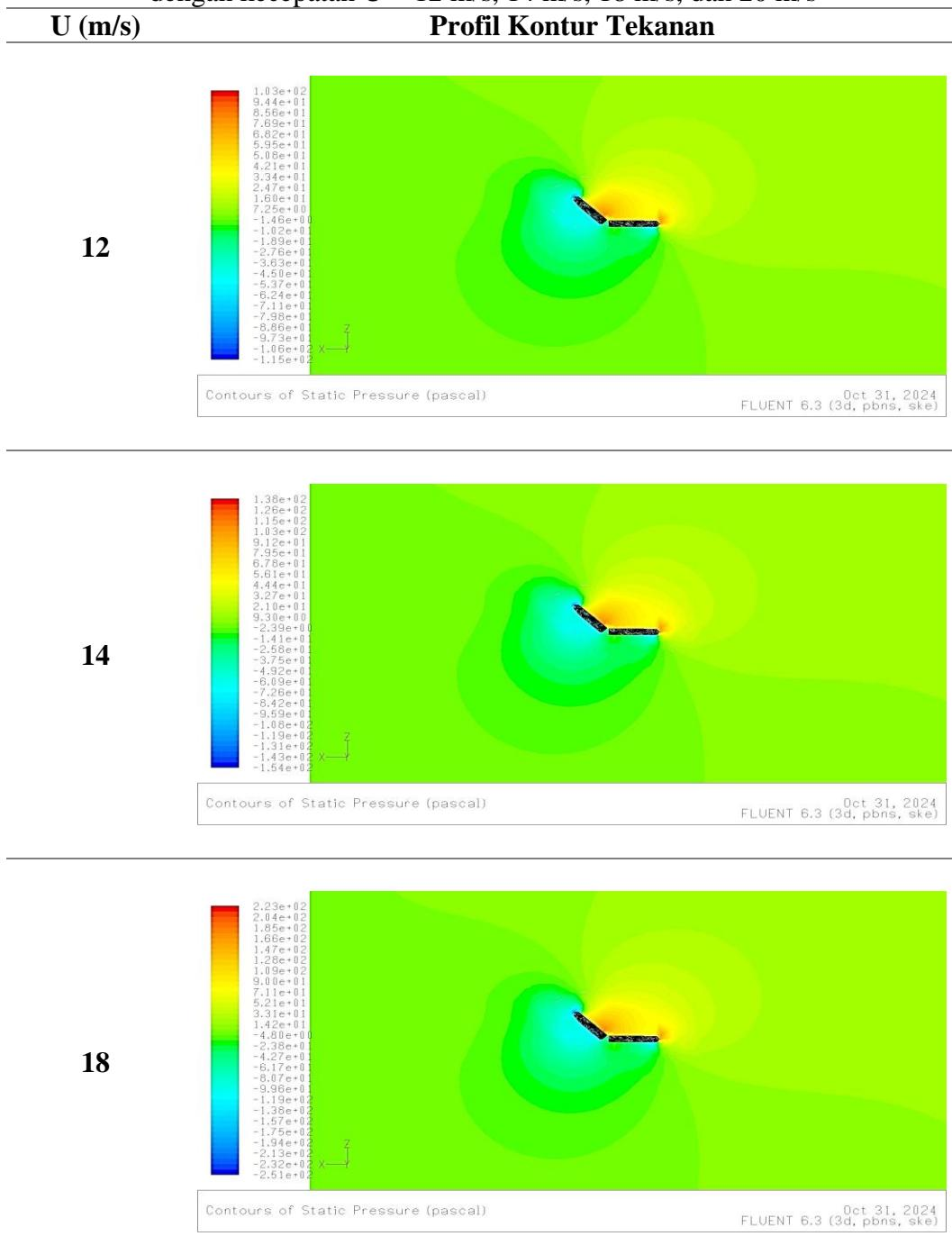
Lanjutan tabel A. 29 Profil kontur tekanan pada *stabilizer* dan *rudder* untuk sudut ( $\delta = 45^\circ$ ) dengan kecepatan  $U = 12 \text{ m/s}$ ,  $14 \text{ m/s}$ ,  $18 \text{ m/s}$ , dan  $20 \text{ m/s}$
