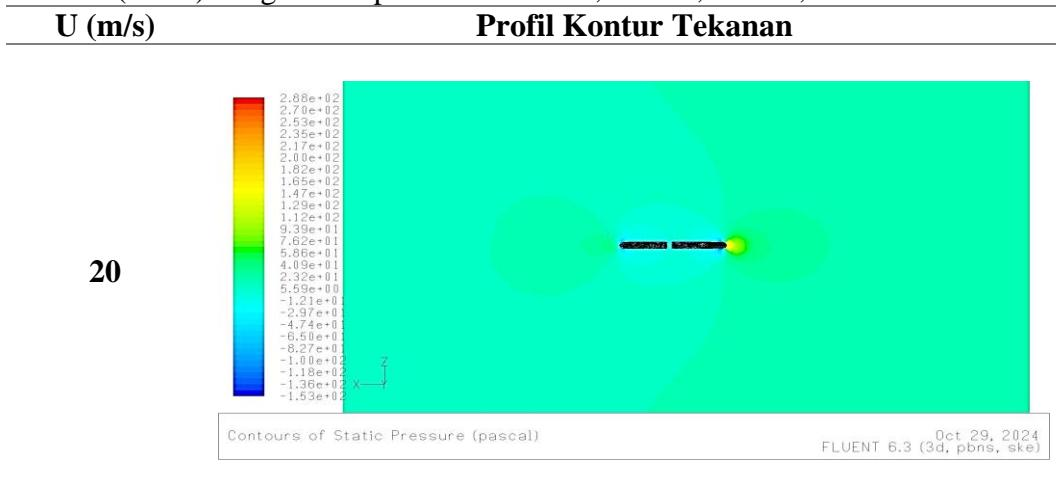
Tabel A. 21 Profil kontur tekanan pada *stabilizer* dan *rudder* untuk sudut ( $\delta = 5^\circ$ ) dengan kecepatan  $U = 12 \text{ m/s}$ ,  $14 \text{ m/s}$ ,  $18 \text{ m/s}$ , dan  $20 \text{ m/s}$
