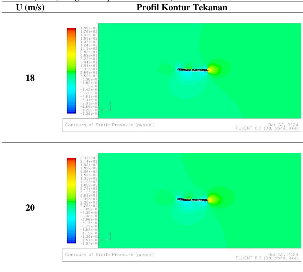
Tabel A. 22 Profil kontur tekanan pada *stabilizer* dan *rudder* untuk sudut ( $\delta = 10^\circ$ ) dengan kecepatan  $U = 12 \text{ m/s}$ ,  $14 \text{ m/s}$ ,  $18 \text{ m/s}$ , dan  $20 \text{ m/s}$
