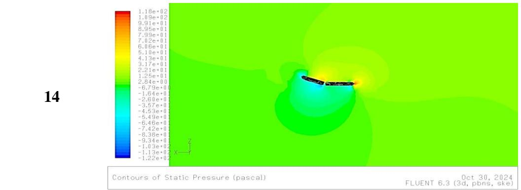
Lanjutan tabel A. 24 Profil kontur tekanan pada *stabilizer* dan *rudder* untuk sudut ( $\delta = 20^\circ$ ) dengan kecepatan  $U = 12 \text{ m/s}$ ,  $14 \text{ m/s}$ ,  $18 \text{ m/s}$ , dan  $20 \text{ m/s}$
