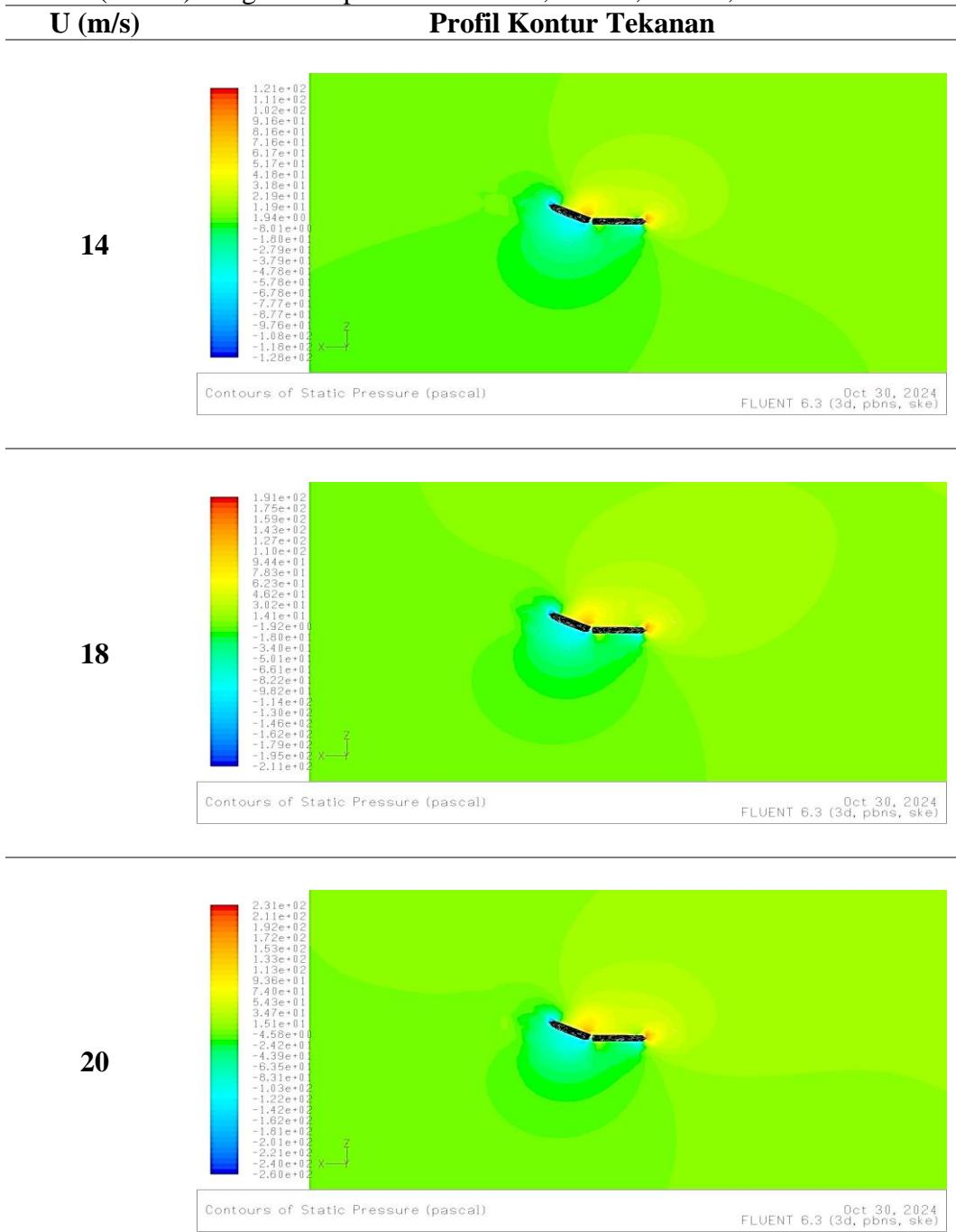
Tabel A. 26 Profil kontur tekanan pada *stabilizer* dan *rudder* untuk sudut ( $\delta = 30^\circ$ ) dengan kecepatan  $U = 12 \text{ m/s}$ ,  $14 \text{ m/s}$ ,  $18 \text{ m/s}$ , dan  $20 \text{ m/s}$
