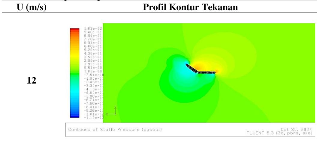
Lanjutan tabel A. 28 Profil kontur tekanan pada *stabilizer* dan *rudder* untuk sudut ( $\delta = 40^\circ$ ) dengan kecepatan  $U = 12 \text{ m/s}$ ,  $14 \text{ m/s}$ ,  $18 \text{ m/s}$ , dan  $20 \text{ m/s}$
