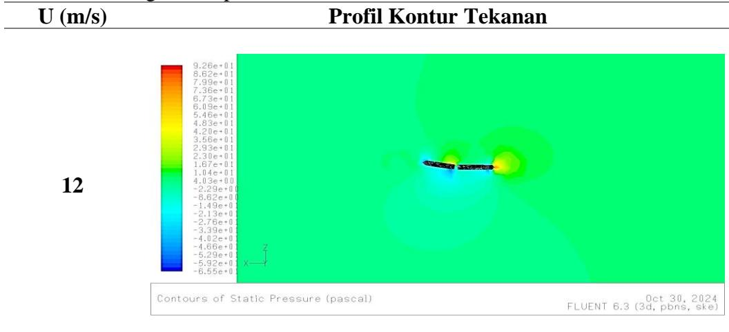
Lanjutan tabel A. 22 Profil kontur tekanan pada *stabilizer* dan *rudder* untuk sudut ( $\delta = 10^\circ$ ) dengan kecepatan  $U = 12 \text{ m/s}$ ,  $14 \text{ m/s}$ ,  $18 \text{ m/s}$ , dan  $20 \text{ m/s}$
