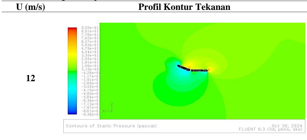
Lanjutan tabel A. 25 Profil kontur tekanan pada *stabilizer* dan *rudder* untuk sudut ( $\delta = 25^\circ$ ) dengan kecepatan  $U = 12 \text{ m/s}$ ,  $14 \text{ m/s}$ ,  $18 \text{ m/s}$ , dan  $20 \text{ m/s}$
