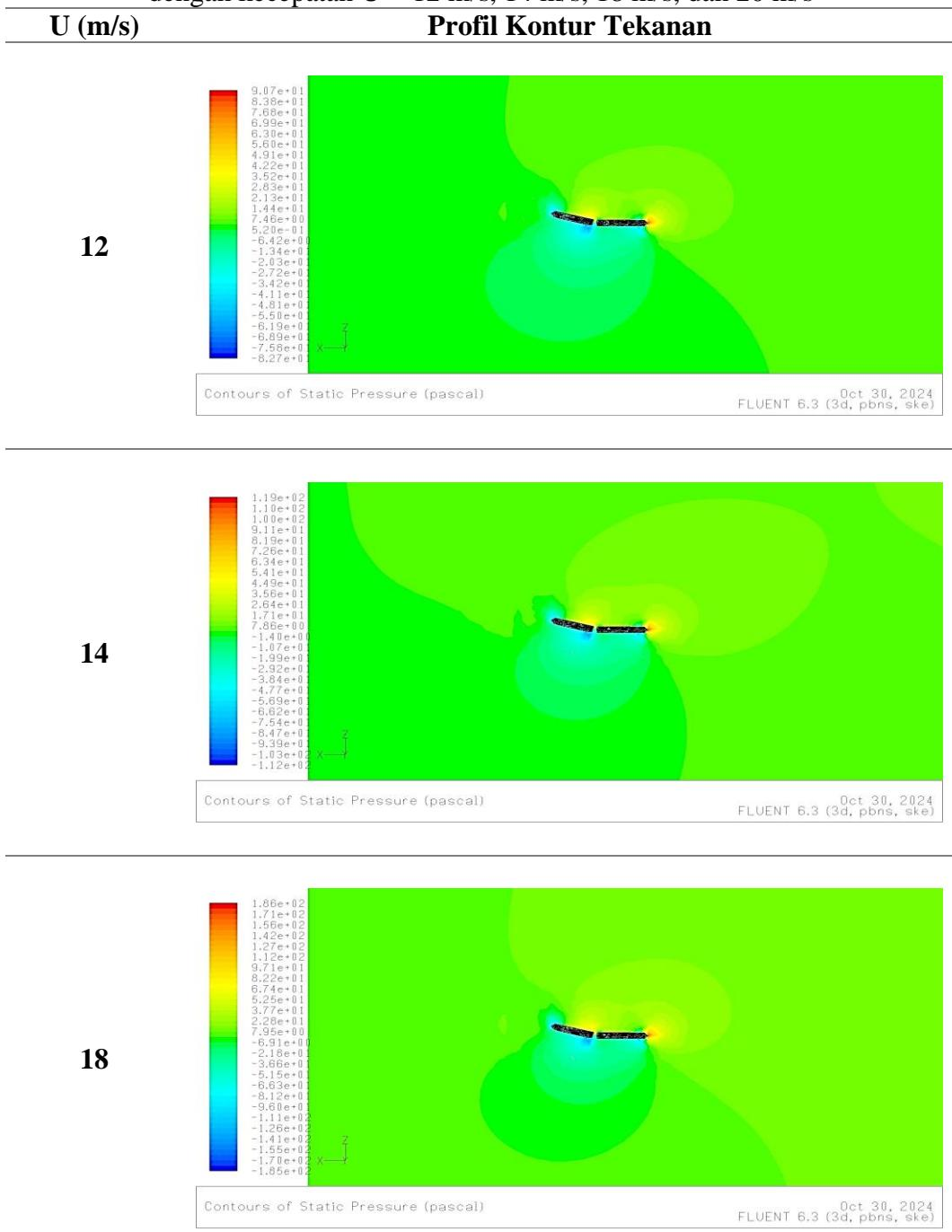
Lanjutan tabel A. 23 Profil kontur tekanan pada *stabilizer* dan *rudder* untuk sudut ( $\delta = 15^\circ$ ) dengan kecepatan  $U = 12 \text{ m/s}$ ,  $14 \text{ m/s}$ ,  $18 \text{ m/s}$ , dan  $20 \text{ m/s}$
