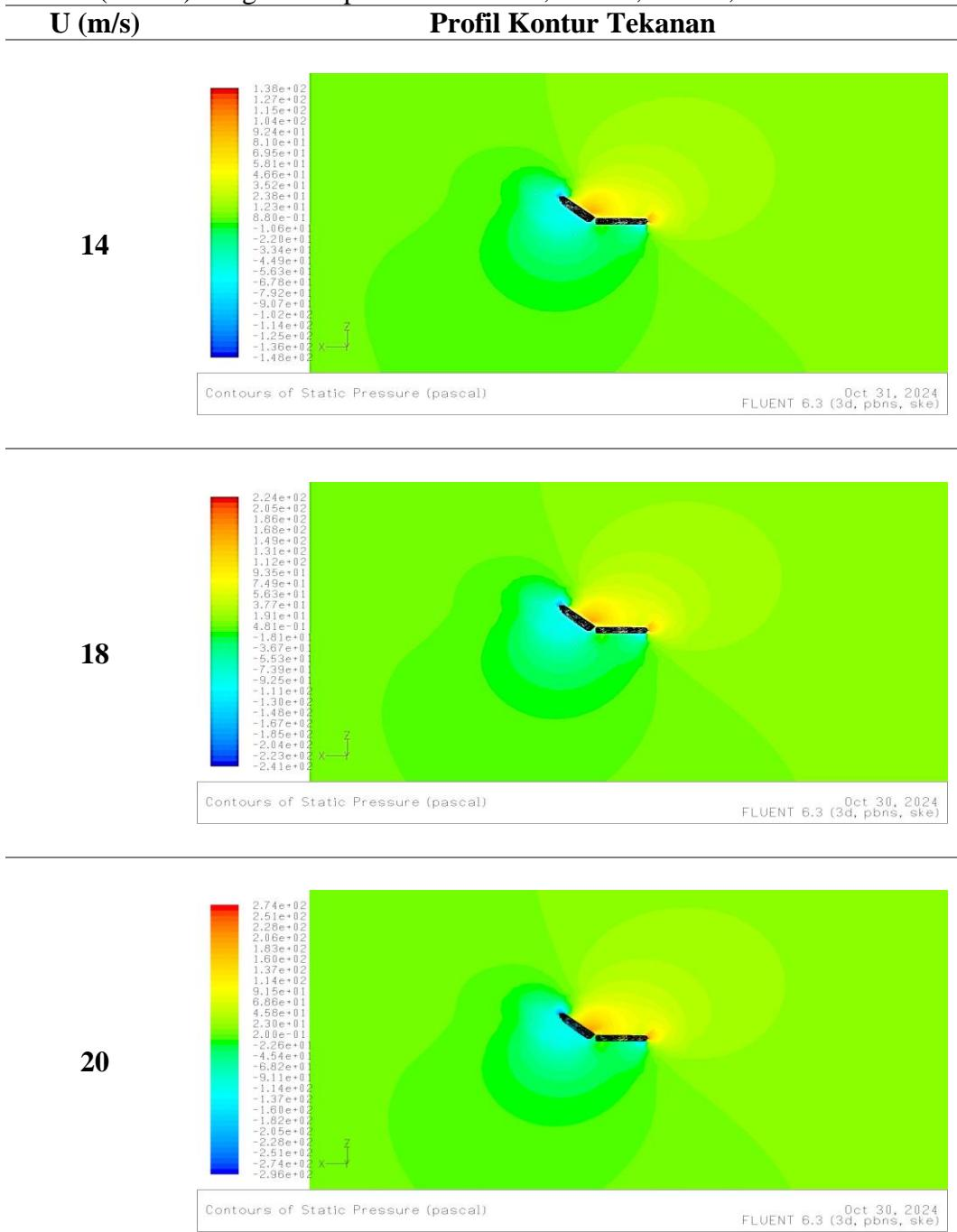
Tabel A. 29 Profil kontur tekanan pada *stabilizer* dan *rudder* untuk sudut ( $\delta = 45^\circ$ ) dengan kecepatan  $U = 12 \text{ m/s}$ ,  $14 \text{ m/s}$ ,  $18 \text{ m/s}$ , dan  $20 \text{ m/s}$
