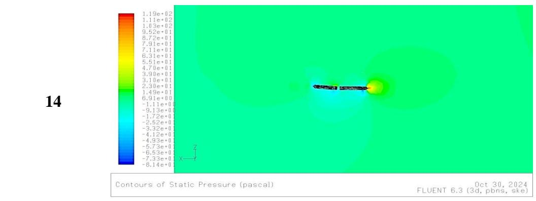
Lanjutan tabel A. 21 Profil kontur tekanan pada *stabilizer* dan *rudder* untuk sudut ( $\delta = 5^\circ$ ) dengan kecepatan  $U = 12 \text{ m/s}$ ,  $14 \text{ m/s}$ ,  $18 \text{ m/s}$ , dan  $20 \text{ m/s}$
