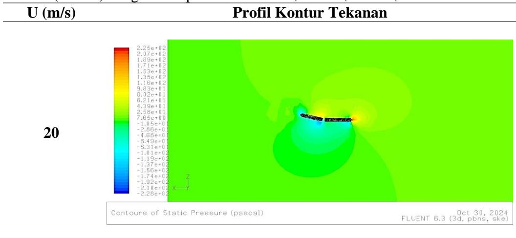
Tabel A. 24 Profil kontur tekanan pada *stabilizer* dan *rudder* untuk sudut ( $\delta = 20^\circ$ ) dengan kecepatan  $U = 12 \text{ m/s}$ ,  $14 \text{ m/s}$ ,  $18 \text{ m/s}$ , dan  $20 \text{ m/s}$
