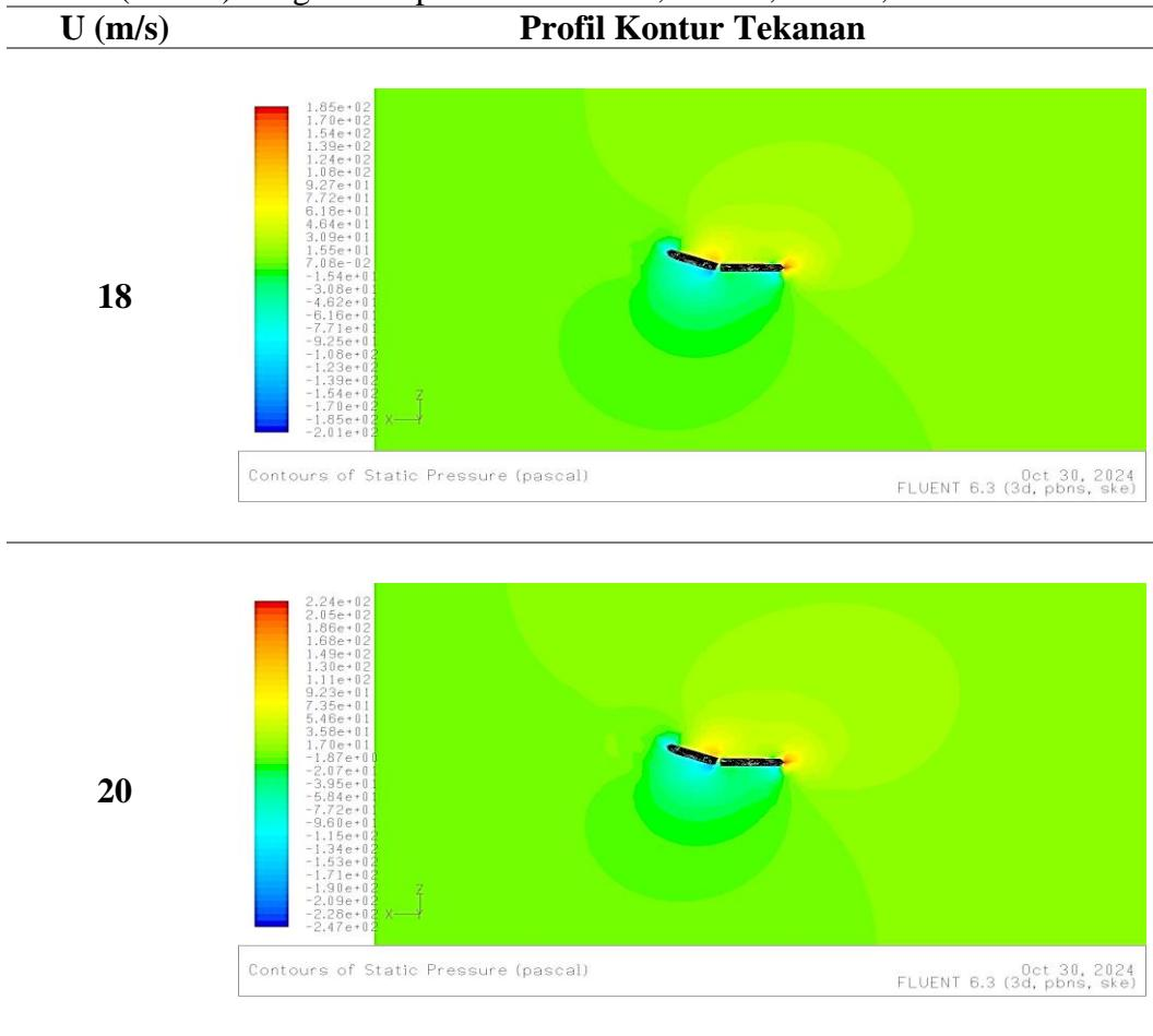
Tabel A. 25 Profil kontur tekanan pada *stabilizer* dan *rudder* untuk sudut ( $\delta = 25^\circ$ ) dengan kecepatan  $U = 12 \text{ m/s}$ ,  $14 \text{ m/s}$ ,  $18 \text{ m/s}$ , dan  $20 \text{ m/s}$
