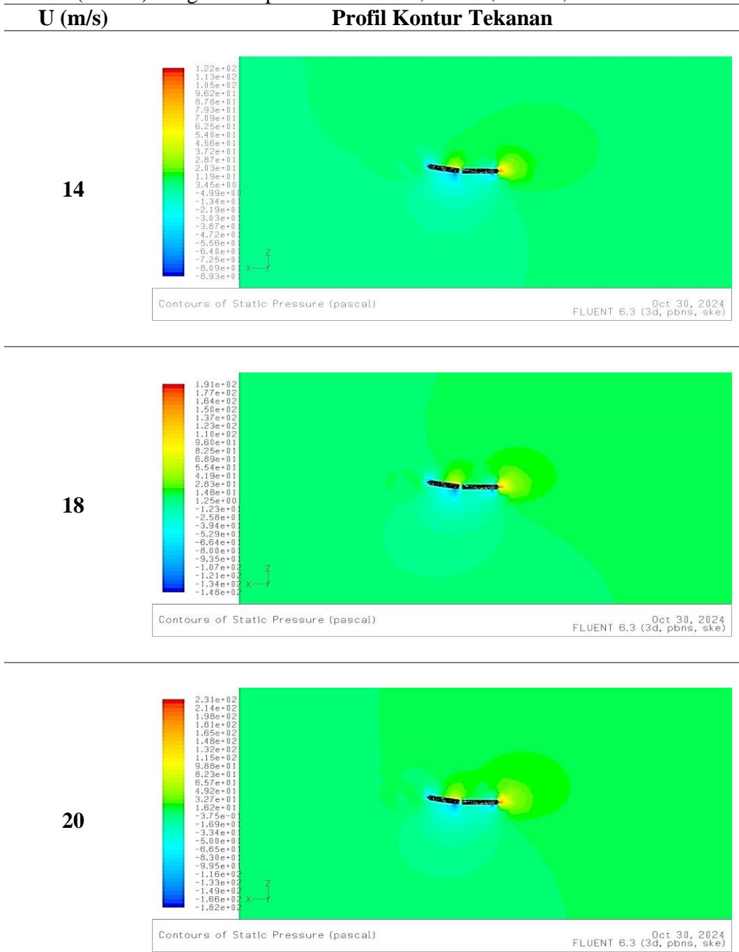
Tabel A. 23 Profil kontur tekanan pada *stabilizer* dan *rudder* untuk sudut ( $\delta = 15^\circ$ ) dengan kecepatan  $U = 12 \text{ m/s}$ ,  $14 \text{ m/s}$ ,  $18 \text{ m/s}$ , dan  $20 \text{ m/s}$
