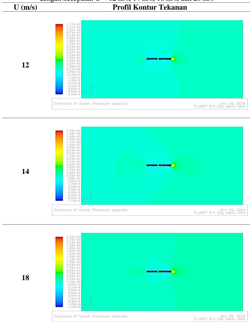
Lanjutan tabel A. 20 Profil kontur tekanan pada *stabilizer* dan *rudder* untuk sudut ( $\delta = 0^\circ$ ) dengan kecepatan  $U = 12 \text{ m/s}$ ,  $14 \text{ m/s}$ ,  $18 \text{ m/s}$ , dan  $20 \text{ m/s}$
