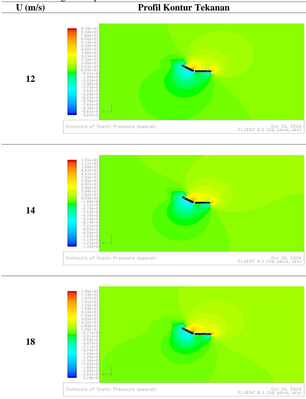
Lanjutan tabel A. 26 Profil kontur tekanan pada *stabilizer* dan *rudder* untuk sudut ( $\delta = 30^\circ$ ) dengan kecepatan  $U = 12 \text{ m/s}$ ,  $14 \text{ m/s}$ ,  $18 \text{ m/s}$ , dan  $20 \text{ m/s}$
