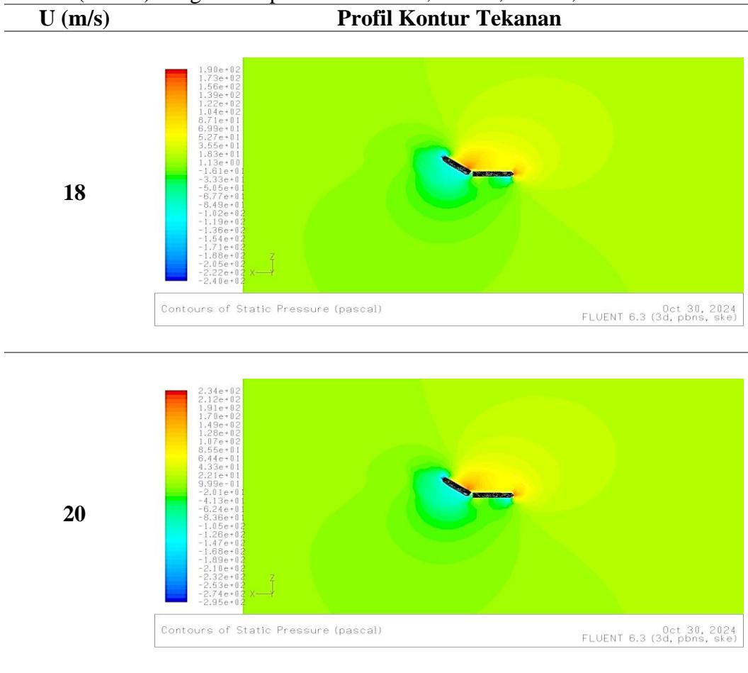
Tabel A. 28 Profil kontur tekanan pada *stabilizer* dan *rudder* untuk sudut ( $\delta = 40^\circ$ ) dengan kecepatan  $U = 12 \text{ m/s}$ ,  $14 \text{ m/s}$ ,  $18 \text{ m/s}$ , dan  $20 \text{ m/s}$
