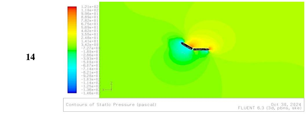
Lanjutan tabel A. 27 Profil kontur tekanan pada *stabilizer* dan *rudder* untuk sudut ( $\delta = 35^\circ$ ) dengan kecepatan  $U = 12 \text{ m/s}$ ,  $14 \text{ m/s}$ ,  $18 \text{ m/s}$ , dan  $20 \text{ m/s}$
