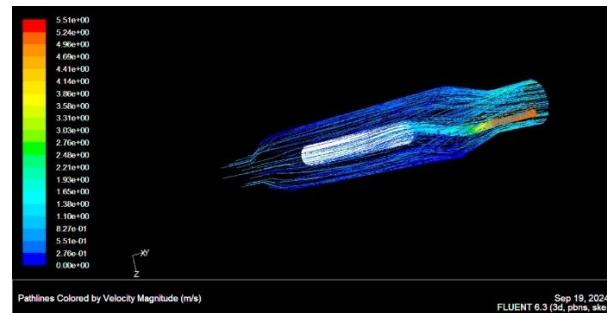
Tekanan (P) Max. = 118,61 mmHg, Kecepatan aliran (v) Max. = 5,5 m/s
