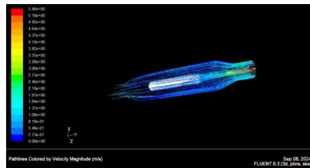
Tekanan (P) Max. = 121,244 mmHg, Kecepatan aliran (v) Max. = 5,4 m/s
