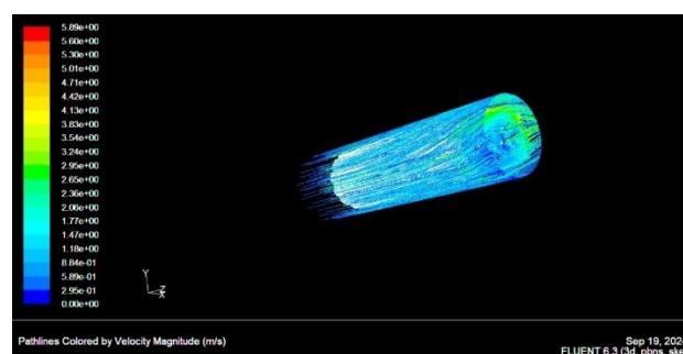
Tekanan (P) Max. = 140,85 mmHg, Kecepatan aliran (v) Max. = 5,8 m/s
