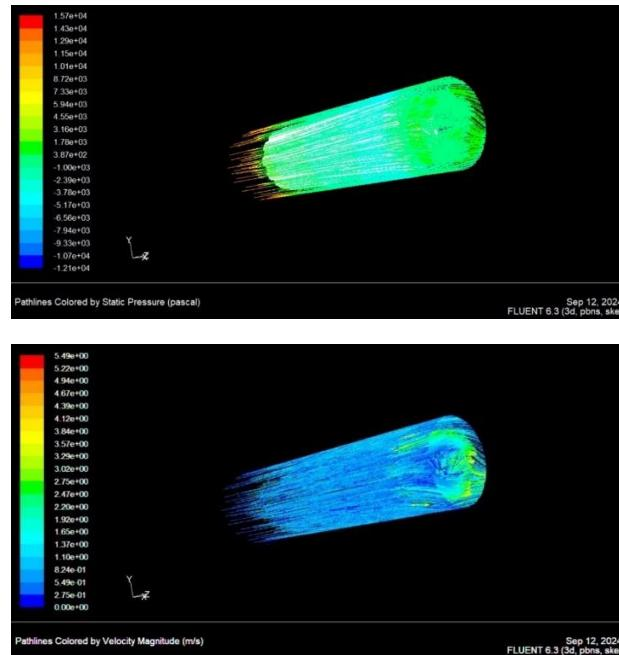
Tekanan (P) Max. = 111,19 mmHg, Kecepatan aliran (v) Max. = 5,4 m/s
