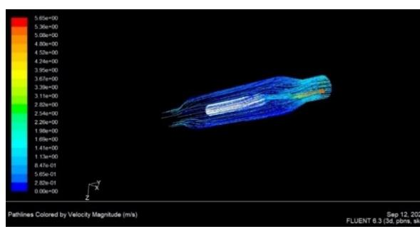
Tekanan (P) Max. = 119,06 mmHg, Kecepatan aliran (v) Max. = 5,7 m/s
