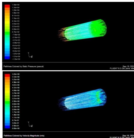
Tekanan (P) Max. = 111,31 mmHg, Kecepatan aliran (v) Max. = 5,8 m/s
