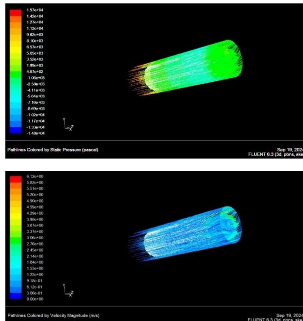
Tekanan (P) Max. = 117,97 mmHg, Kecepatan aliran (v) Max. = 6,1 m/s
