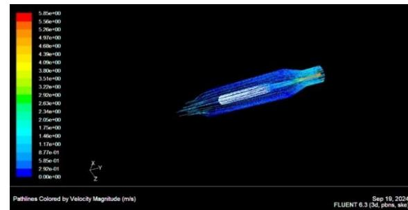
Tekanan (P) Max. = 117,72 mmHg, Kecepatan aliran (v) Max. = 5,8 m/s
