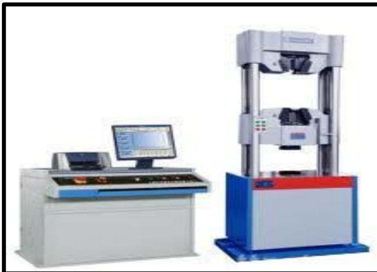
**Gambar 2.5** Mesin uji tarik
