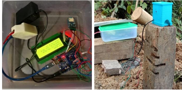
(a) Pemasangan alat ukur curah hujan.
