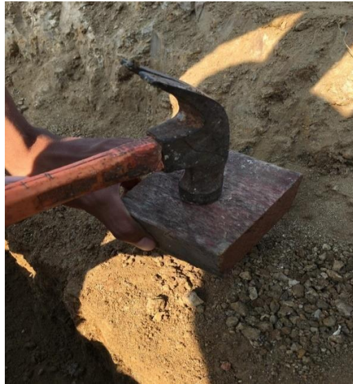
Pengambilan sampel tanah tidak terusik
